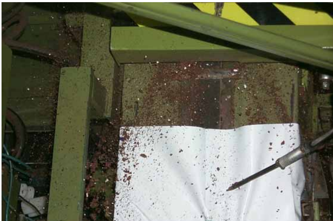
Photo 18 : Captage partiel des émissions lors du compactage.
