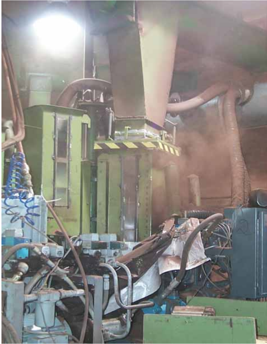
Photo 3 : Émissions sur la partie supérieure lors de l'étape de remplissage
