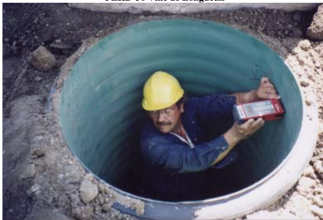
Figure 3.20 - Essai 1.2.B : Remplissage de la tranchée B par du sable et du remblai - PEHD-36 Ville de Longueuil
