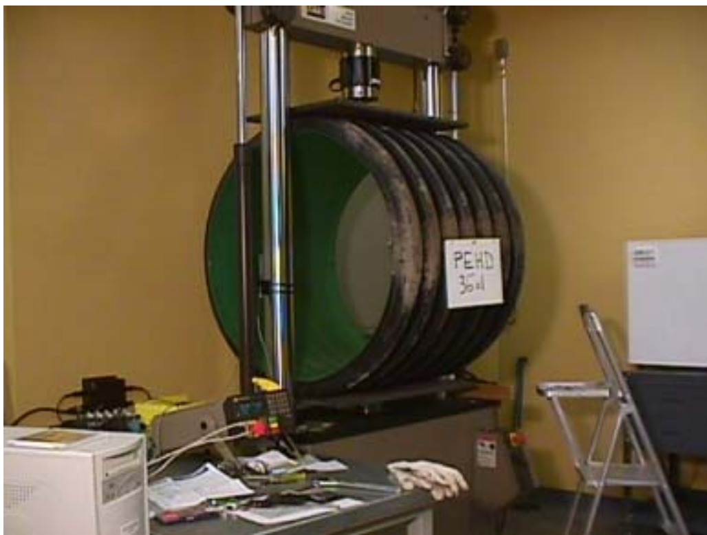
Figure 3.3 - PEHD-36 : Essai en laboratoire
