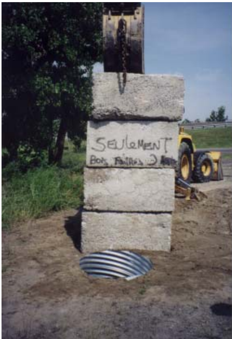
Figure 3.13 - Essai 1.1.A : Surcharge avec 4 blocs de béton posés sur le sable remblayé près du TTAOG-36 - 19 juin 2001
