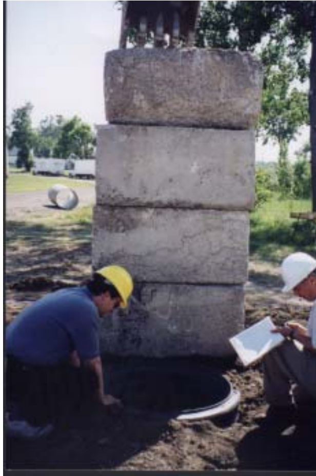
Figure 3.22 - Essai 1.2.B : Surcharge par des blocs posés près du PEHD-36 - Ville de Longueuil
