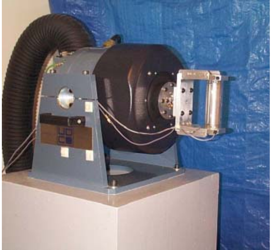
Figure 1 : Générateur de vibrations : Excitateur et amplificateur
