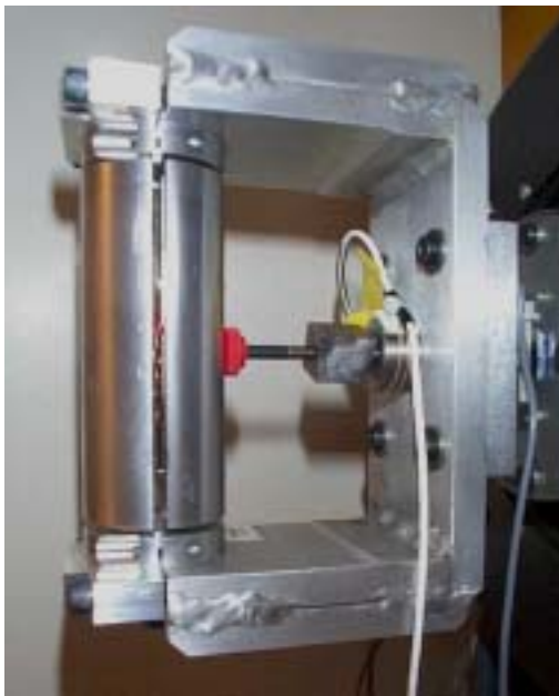
Figure 3 : Étalonnage : force de préhension
