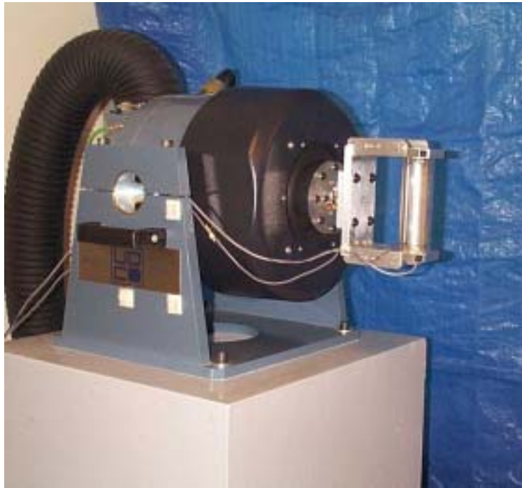
Figure 4 : Vue d'ensemble de la poignée instrumentée sur l'excitateur de vibrations
