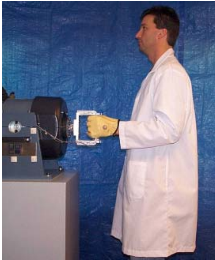
Figure 14 : Représentation du montage pour l'évaluation d'un gant antivibratile.
