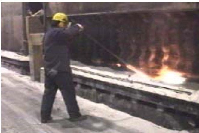
Figure 16 - Grattage de la cuve
