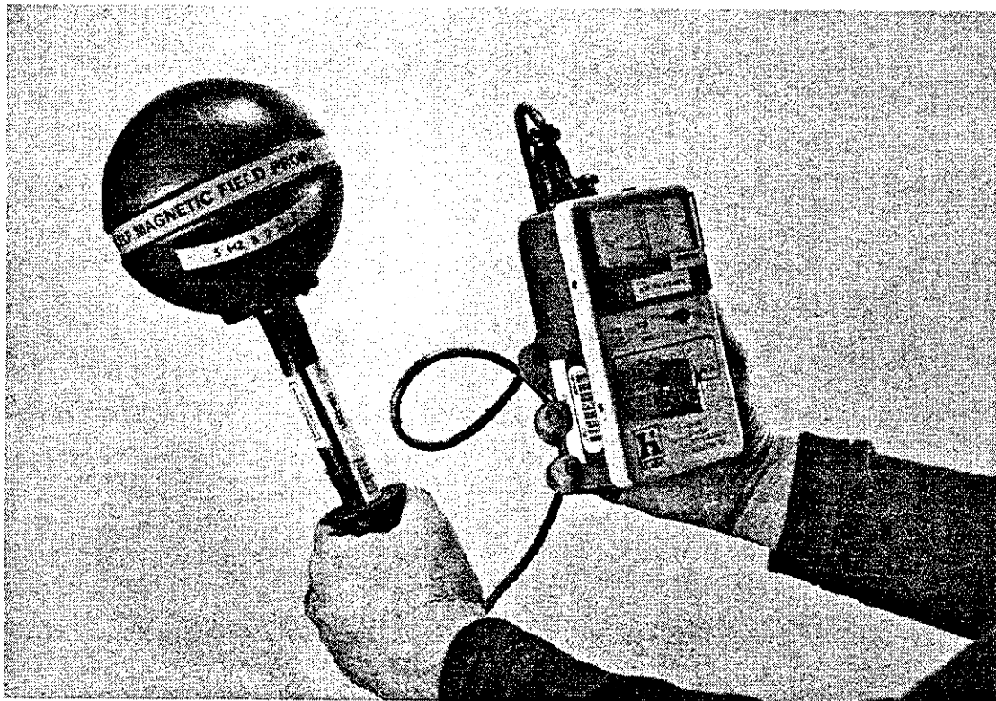
Figure 13 : Teslamètre triaxial Holaday HI-3627 (ayant une bande passante de 5 Hz à 2 kHz et une gamme dynamique allant de 20 nT à 2 mT).
