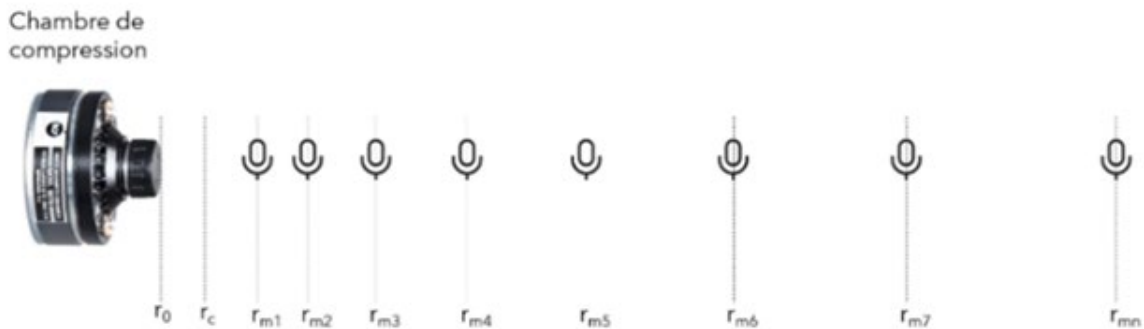
Figure 10. Placement des microphones à une distance r de l'embouchure de la source.
