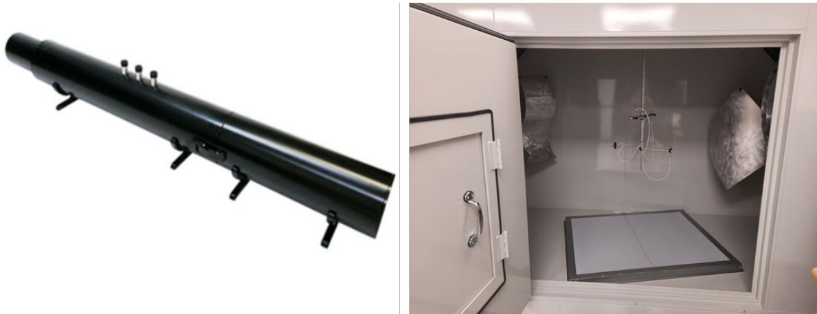
Figure 67. (à gauche) Tube d'impédance; (à droite) Petite cabine réverbérante.
