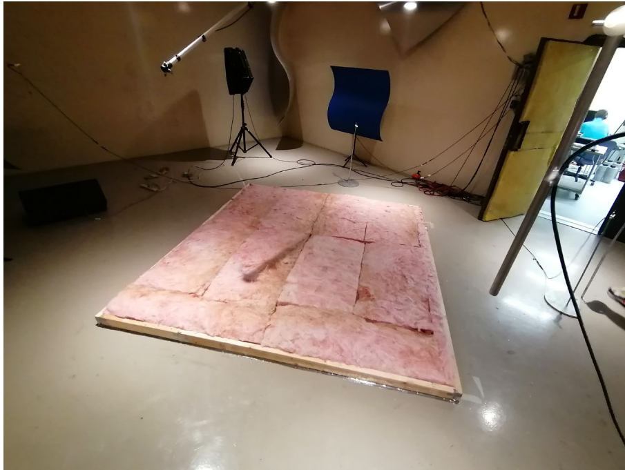
Figure 72. Photo du matériau « laine de verre » installé dans la chambre réverbérante.
