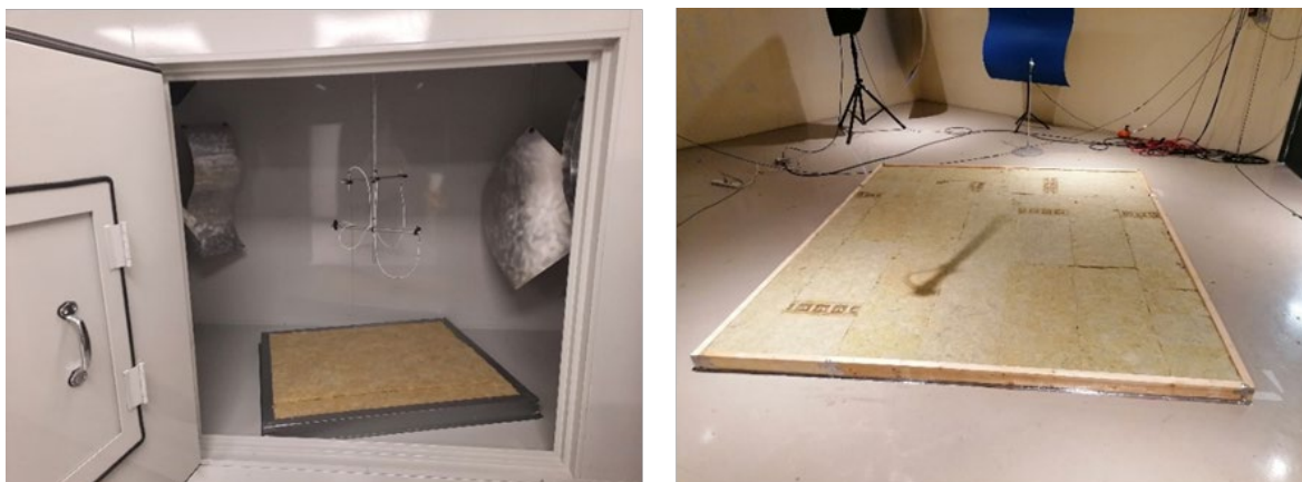
Figure 13. Montage des mesures en petite cabine réverbérante (à gauche) et en chambre réverbérante (à droite) sur l'échantillon de laine de roche.
