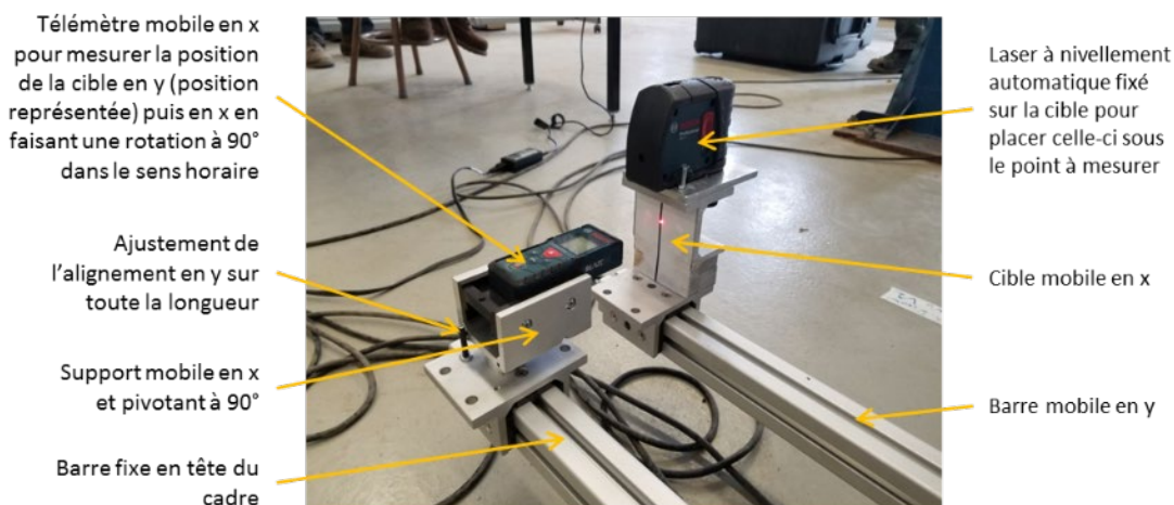
Figure 69. Montage du télémètre, de la cible et du laser à nivellement automatique.
