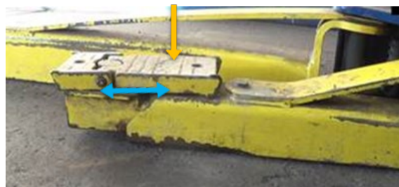
Figure 97. Zone d'atteinte près de la colonne pour les ponts de type Po1 et Po2.
