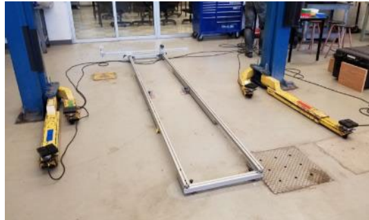
Figure 67. Cadre posé au sol pour le positionnement de la cible sous le point à mesurer.
