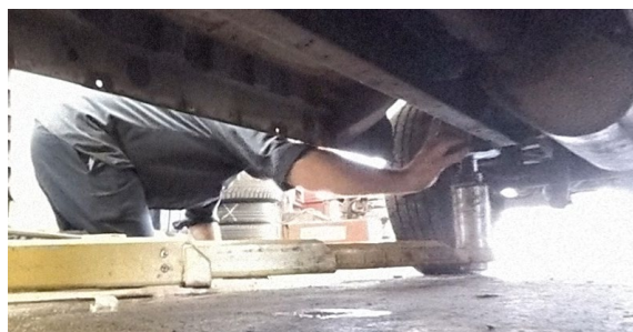
Aligner le patin avec le point de levage et évaluer l'espace entre les deux
