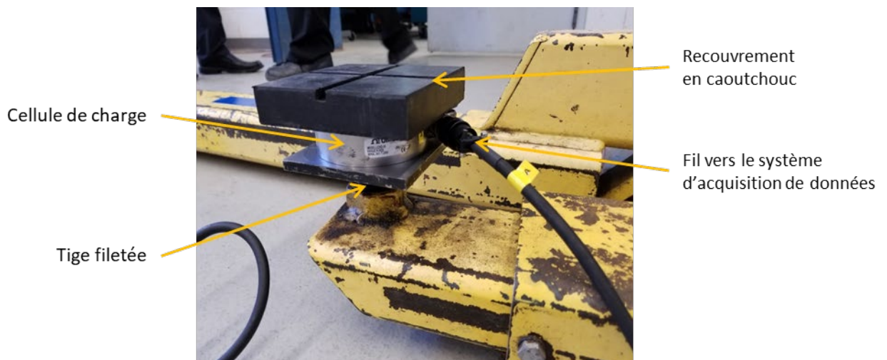
Figure 64. Patin carré modifié pour insérer une cellule de charge.
