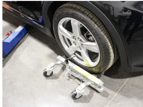
Figure 63. Utilisation d'un chariot placé sous les roues pour surélever et positionner précisément les véhicules électriques lors des essais.
