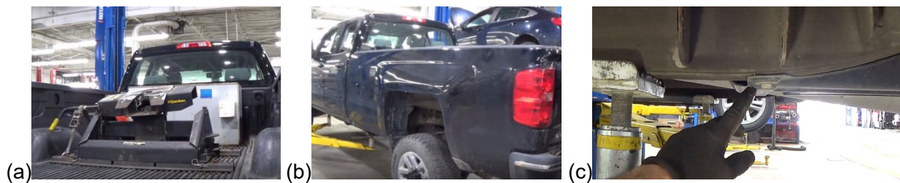
Figure 50. (a) Attelage dans la caisse ; (b) Positionnement des patins de gauche ; (c) Présence d'obstacles empêchant de reculer le patin.
