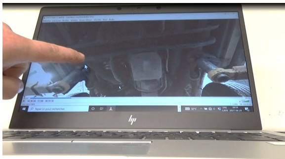
Figure 42. Un technicien explique les précautions à prendre pour placer le patin à proximité du catalyseur, en plus de la barre transversale qui fait obstacle.
