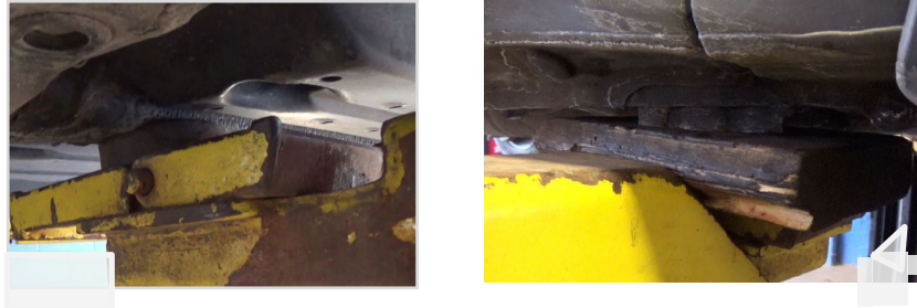
Figure 31. Points de levage de véhicules de luxe.
