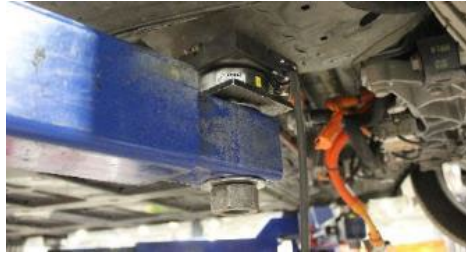
Figure 94. Accouplement entre le patin instrumenté et le bras du PEV.
