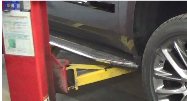
Figure 25. Hauteur du patin pour éviter le contact entre le renfort du bras et le marchepied.
