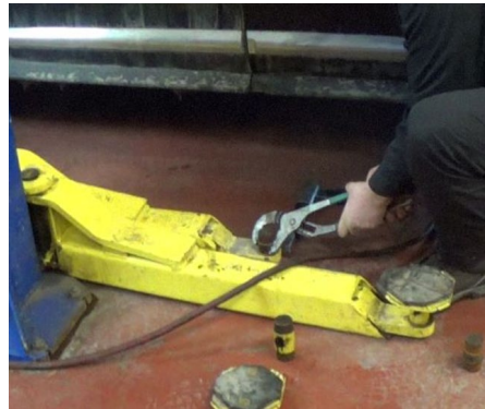
Figure 28. Technicien retirant une rallonge de patin prise dans la rouille.
