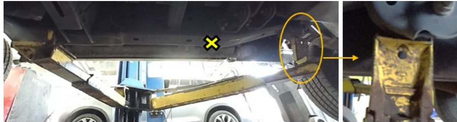
Figure 51. Camionnette chargée, position des patins arrière plus reculée que le point recommandé (croix) pour avoir une meilleure base de sustentation.
