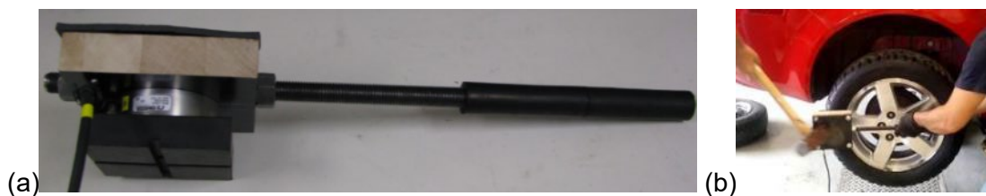
Figure 86. (a) Montage de la cellule de charge pour les coups de masse au pneu arrière droit – (b) Application de la force au pneu arrière droit.
