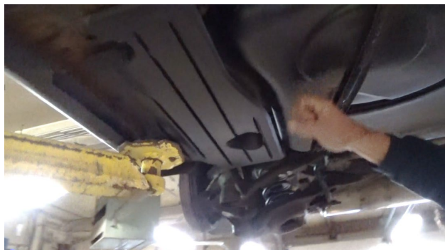
Figure 21. Panneaux de plastique empêchant d'utiliser des points de levage internes.
