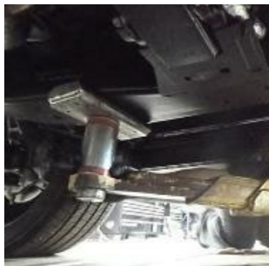
Figure 27. Légère inclinaison de la rallonge-patin lors de la mise en charge.
