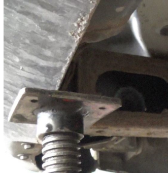
Chandelle avec ajustement par vis
