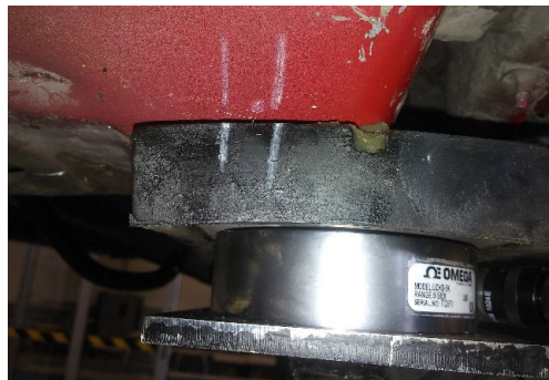
Figure 8. Patin, avec coussinet en caoutchouc, positionné décentré avec marques alignées avant d'exercer des poussées sur le véhicule.
