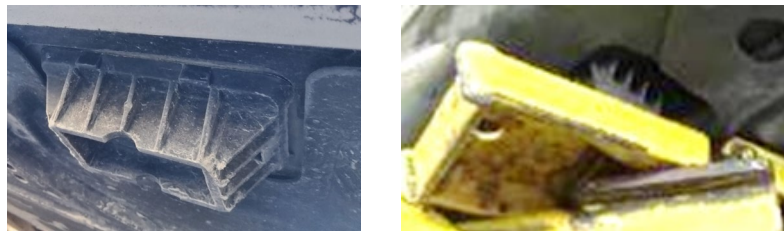
Figure 31. Points de levage de véhicules de luxe.
