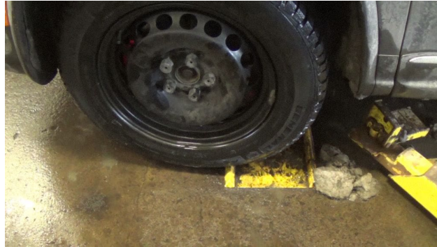
Figure 17. Position du pneu AV-GA sur la butée avant de la cale.
