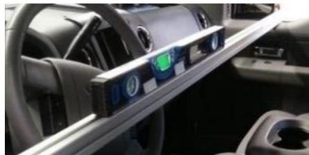
Figure 72. Niveau numérique placé pour la mesure du tangage du véhicule.
