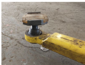
Figure 62. Exemple de patin vissable, retirable et avec une zone d'accouplement basse sur la dernière section du bras.
