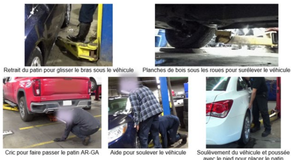
Figure 35. Techniques pour faire passer le bras/patin sous les véhicules.
