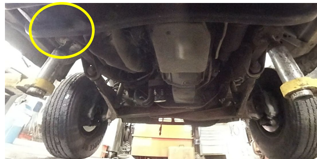
Figure 42. Un technicien explique les précautions à prendre pour placer le patin à proximité du catalyseur, en plus de la barre transversale qui fait obstacle.
