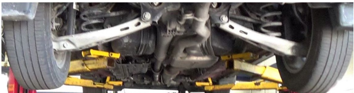
Figure 29. Exemple de points de levage internes et d'ajustements en hauteur des patins (vue depuis l'arrière du véhicule).
