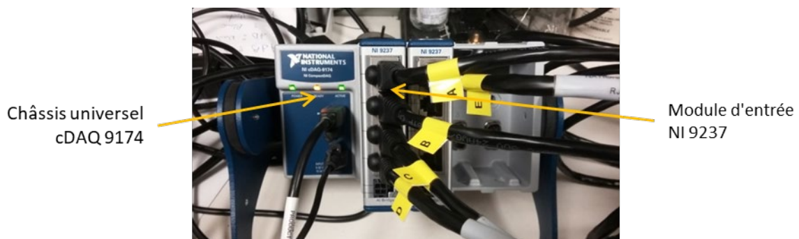
Figure 65. Système d'acquisition des signaux issus des cellules de charge (patins A à D).
