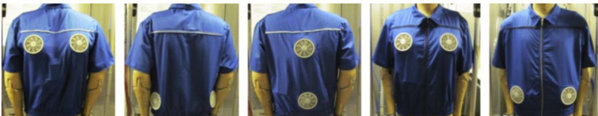
Figure 18. Prototypes d'un vêtement refroidissant à ventilateur avec deux petits ventilateurs et des ouvertures situées à différents endroits du torse (de gauche à droite) : le haut du dos, le bas du dos, le milieu du dos, la poitrine et le ventre (Zhao, Mengmeng et al. , 2013).
