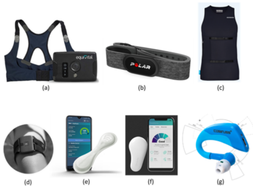
Figure 4. Exemples de dispositifs portables, disponibles dans le commerce, pour surveiller les signaux biométriques utiles pour l'évaluation des contraintes thermophysiological pendant le travail actif : (a) ceinture pectorale EQ02 LifeMonitor (par Equivital™, New York, NY, É.-U.), (b) ceinture pectorale H10 (par Polar, Kempele, Finlande), (c) chandail biométrique (par Hexoskin, Montréal, QC, Canada), (d) patch électronique Kenzen™ (par Kenzen, New York, NY, É.-U.), (e) patch électronique Cardiomo™ (par Cardiomo, New York, NY, É.-U.), (f) patch électronique VitalPatch® (par Vitalconnect, San Jose, CA, É.-U.), (g) dispositif intra-auriculaire One™ (par Cosinuss° One™, Munich, BY, Allemagne).
