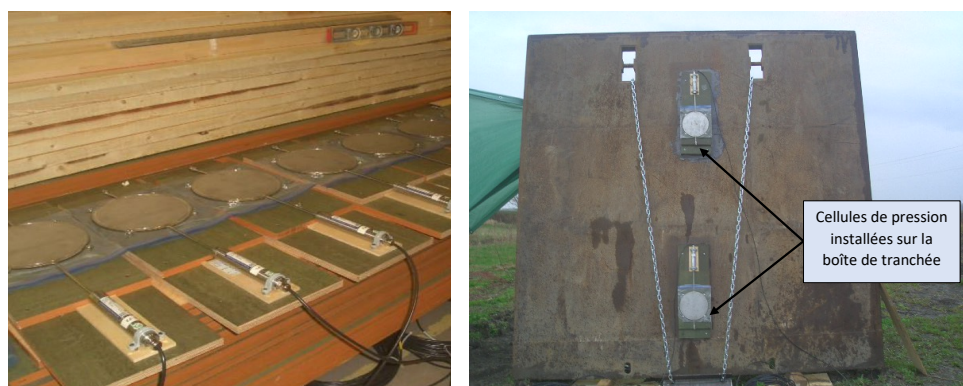
Figure 19. Cellules de pression préparées au laboratoire (gauche) et installées sur la boîte de tranchée (droite).
