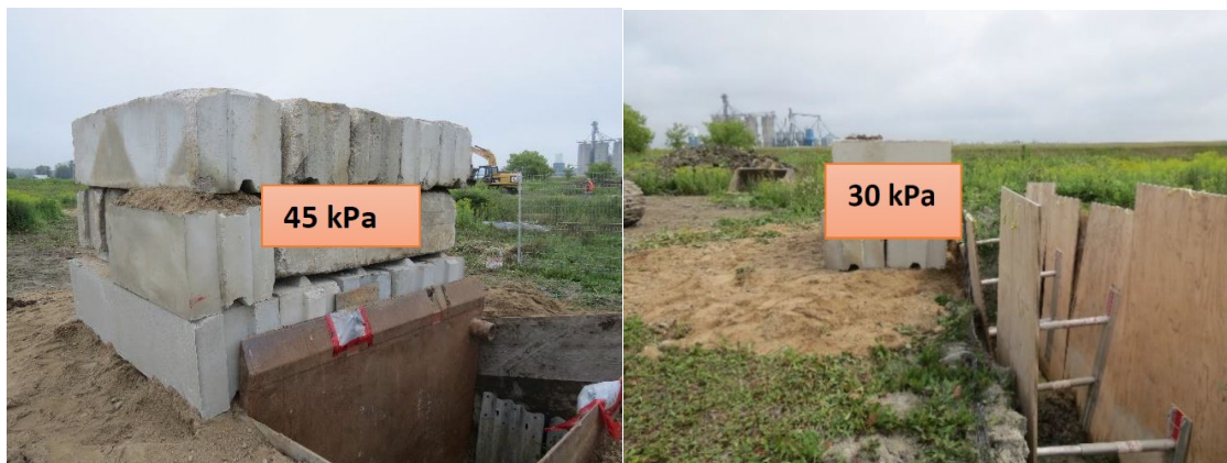
Figure 37. Pression exercée sur le sommet de l'excavation par la surcharge, tranchée B (gauche) et tranchée C (droite).
