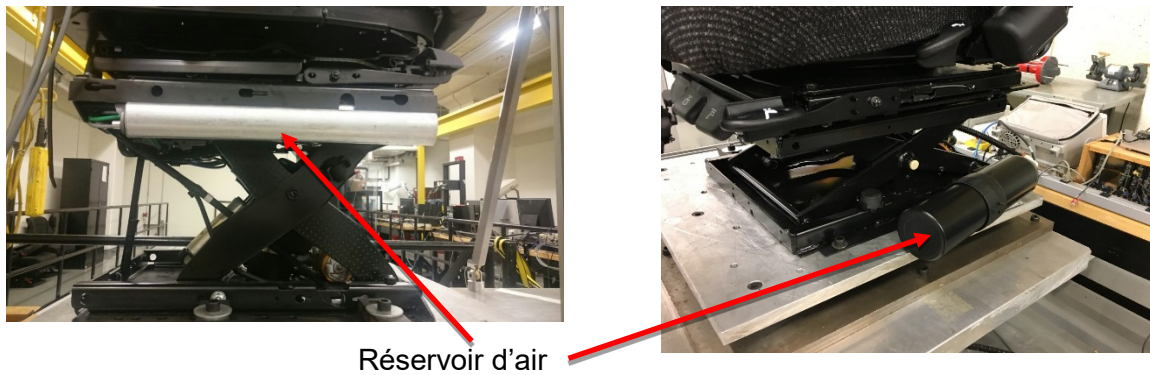
Figure 4.6. Représentations visuelles de mécanismes de suspension dotés d'un réservoir d'air supplémentaire.
