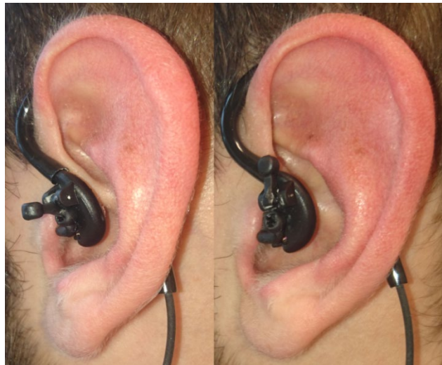
Figure 19. Bouchon dosimétrique installé dans une oreille dans les conditions ouvertes (gauche) ou fermées (droite).
