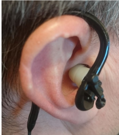
Figure 27. Exemple de port du bouchon dosimétrique lorsque celui-ci est retiré du conduit auditif. Le microphone de mesure est maintenu à proximité de l'entrée du conduit auditif, mais l'atténuation procurée par le protecteur est grandement réduite.
