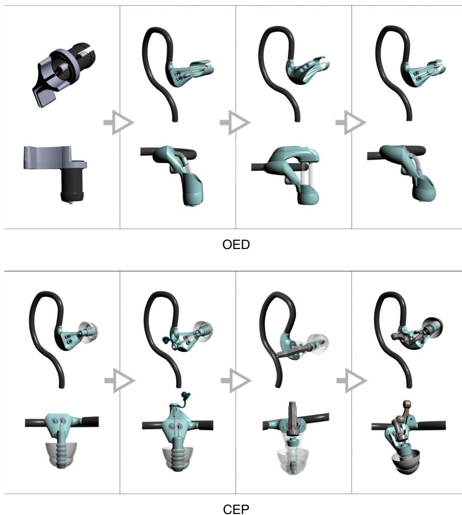
Figure 30. Évolution des dispositifs OED (en haut) et CEP (en bas) au fil des itérations de conception.
