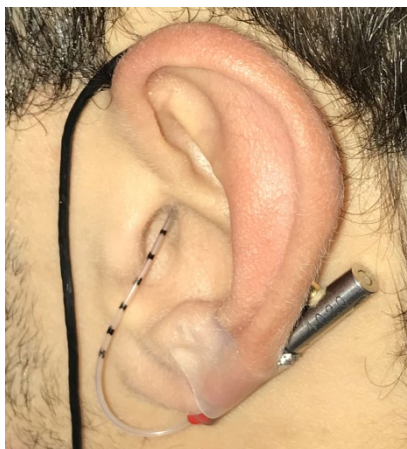
Figure 9. Dispositif (sonde et microphone) utilisé pour les mesures dans le canal auditif. Les repères marqués en noir sur le tube-sonde sont espacés de 4 mm.
