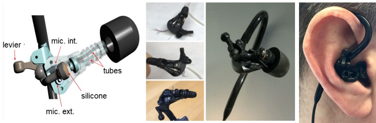
Figure 32. Rendu 3D et images du prototype CEP montrant les différents composants, assemblage et conception globale, ainsi que le port final du prototype ainsi obtenu.
