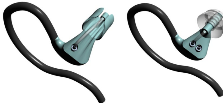
Figure 2. Modèle 3D illustrant l'oreillette de mesure (OED à gauche) et le bouchon dosimétrique (CEP à droite). L'oreillette CEP est conçue pour pouvoir accueillir un embout protecteur de type bouchon.
