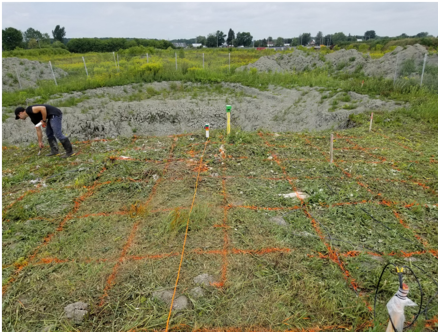
Figure 19. Tranchée A2 et quadrillage adjacent à la peinture orange pour surveiller les mouvements de terrain.
