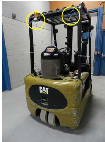
Figure 19. Photo montrant le positionnement des deux microphones installés sur le chariot élévateur (cercles jaunes).
