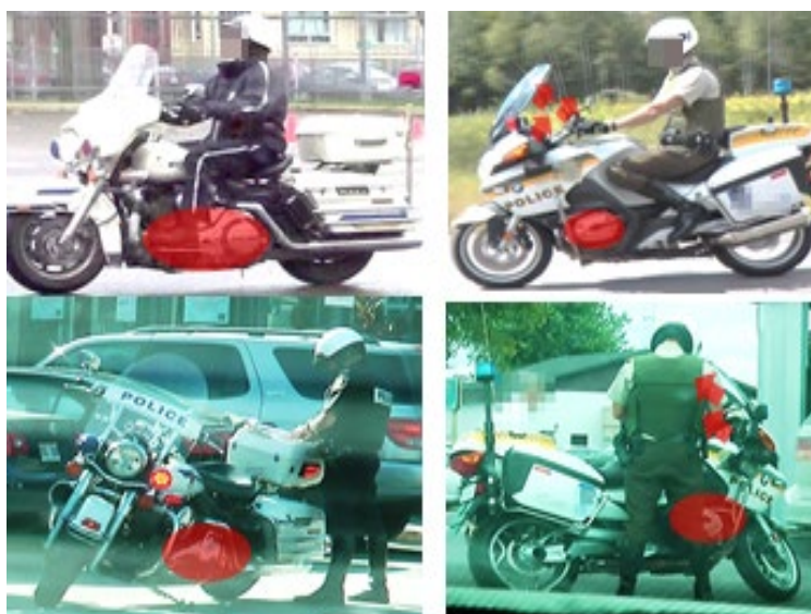
Figure 27. Représentation des zones de chaleurs des motos (indiquées par des flèches et des ellipses rouges) et du positionnement du motard face à ces zones (photos de gauche : Harley-Davidson, photos de droite : BMW).
