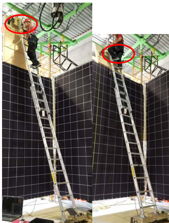
Figure 17. Échelle appuyée en son sommet (à gauche) ou sur les montants (à droite).
