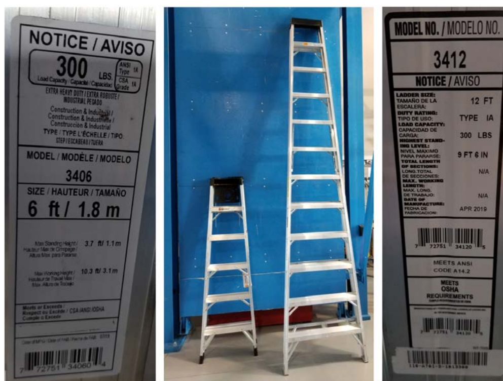
Figure 5. Escabeaux utilisés pour les essais.
