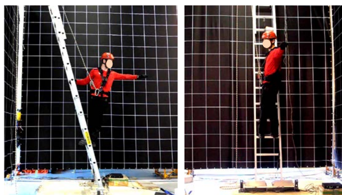
Figure 16. Vérification de la stabilité de l'échelle - Position 3 : retourné (P3).
