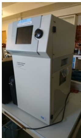
Figure 2. Spectromètre de diamètre de mobilité électrique (EEPS).
