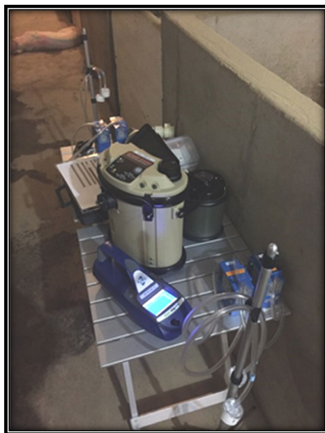
Figure 1. Échantillonnage des bioaérosols d'une porcherie à l'aide d'échantillonneurs à hauts et à très hauts débits (source : laboratoire C. Duchaine).
