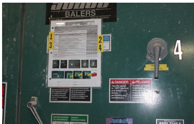
Figure 1. Fiche de cadenassage sur une machine
