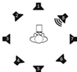
Figure 9. Positionnement des haut-parleurs, du participant et du trépied (tâche connexe) pour les épreuves de localisation.
