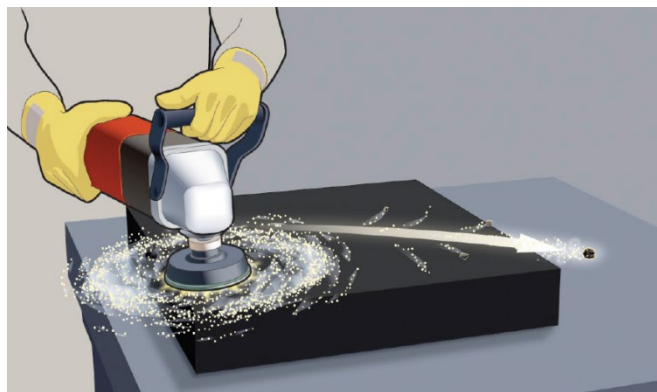
Figure 1. Scénario de dispersion des particules lors du polissage. Source : Goyer et al., 2010.
