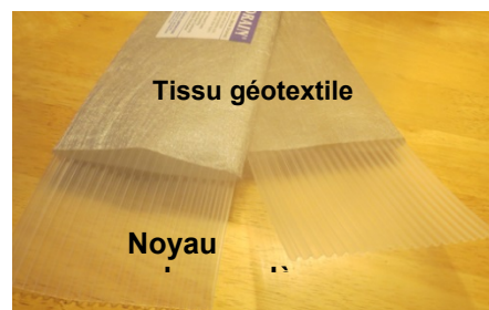
Figure 70. Un géo-drain. Reproduit de Li et Yang (2015) avec la permission d'Elsevier B.V.
