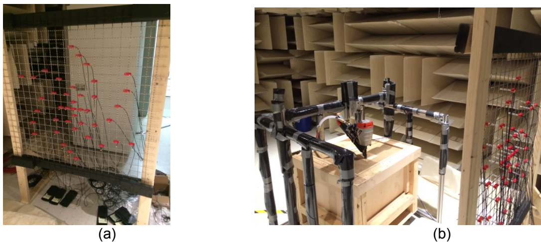
Figure 25 (a) Antenne acoustique et (b) antenne positionnée devant la cloueuse
