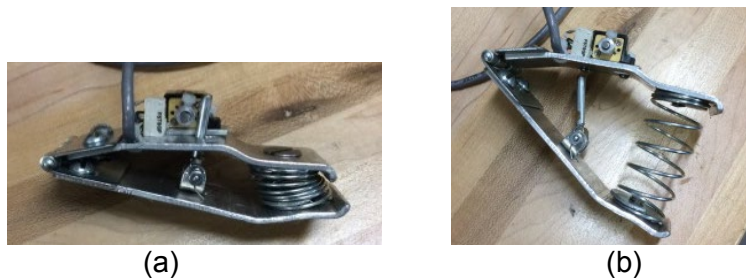
Figure 18 Système de déclenchement à distance : (a) position fermée, prêt à déclencher et (b) position ouverte
