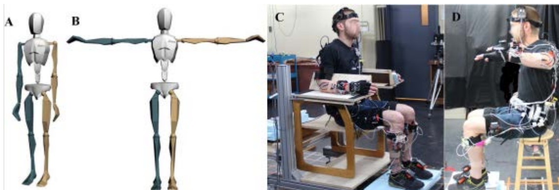
Figure 5.1 Les quatre types de poses de calibrage statique : A = Pose-N ; B = Pose-T; C=Pose-chaise ; D= Pose-tabouret
