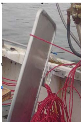
Photo 24 – Panneau séparateur du cordage – incident
