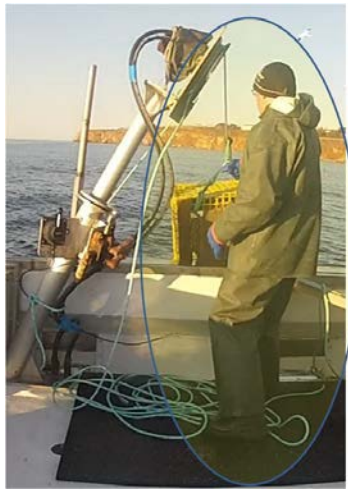
Photo 20 – Haleur incliné pivotant en hauteur-travail optimal
