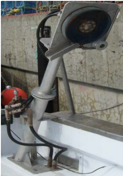
Photo 3 – Haleur incliné pivotant en hauteur
