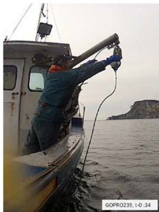
Photo 10 – Insertion du cordage dans un haleur avec potence
