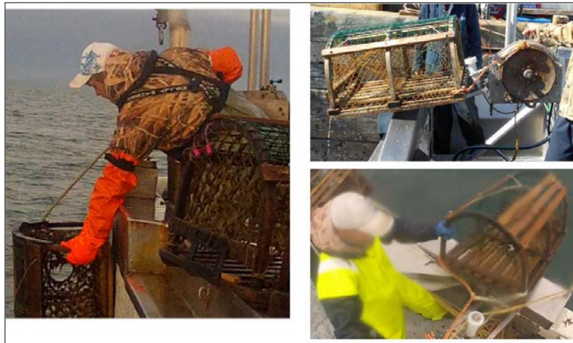
Photo 21 – Haleur bas fixe - attraper et remonter le casier AVANT (image de gauche); haleur fixe éloigné du pavois - attraper et remonter le casier APRÈS (images de droite)
