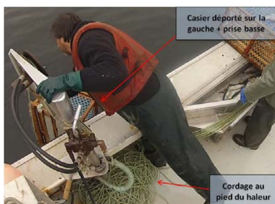
Photo 18 – Attraper et remonter le casier AVANT – haleur incliné pivotant en hauteur
