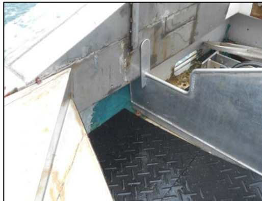
Photo 26 – Mode de fixation et encoche dans le panneau séparateur du bateau K-FC103
