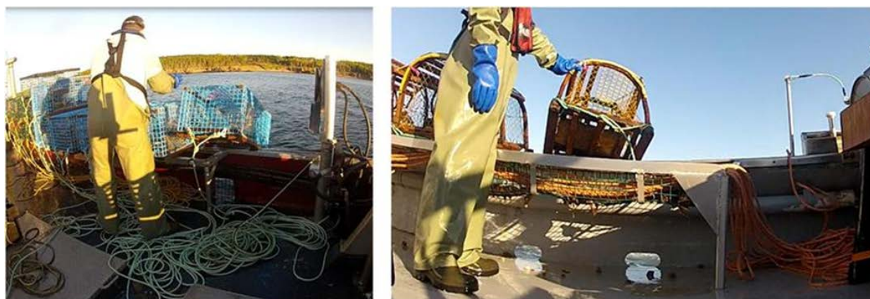
Photo 14 – Position des pieds du préposé avec ou sans cordage sur le pont lors de la remise à l'eau des lignes de casiers.
