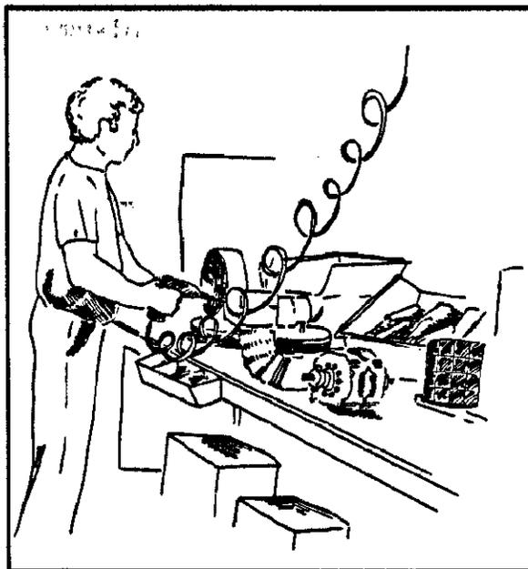
Figure 3.4 : Poste du moteur, assemblage du boîtier de ventilation au moteur.
