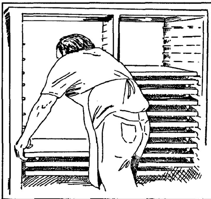
**Figure 3.17 : Poste de la pose du couvercle, prise du couvercle dans le module à moitié vide. À noter : posture contraignante du dos.**
