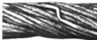
Figure 5. Fil déplacé à cause de l'usure.
