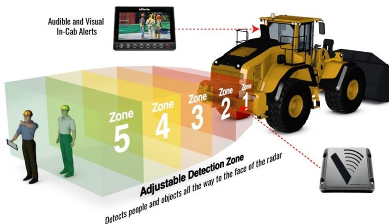
Figure 6. Exemple d'un système de détection de proximité par radar (Source : Preco Electronics).
