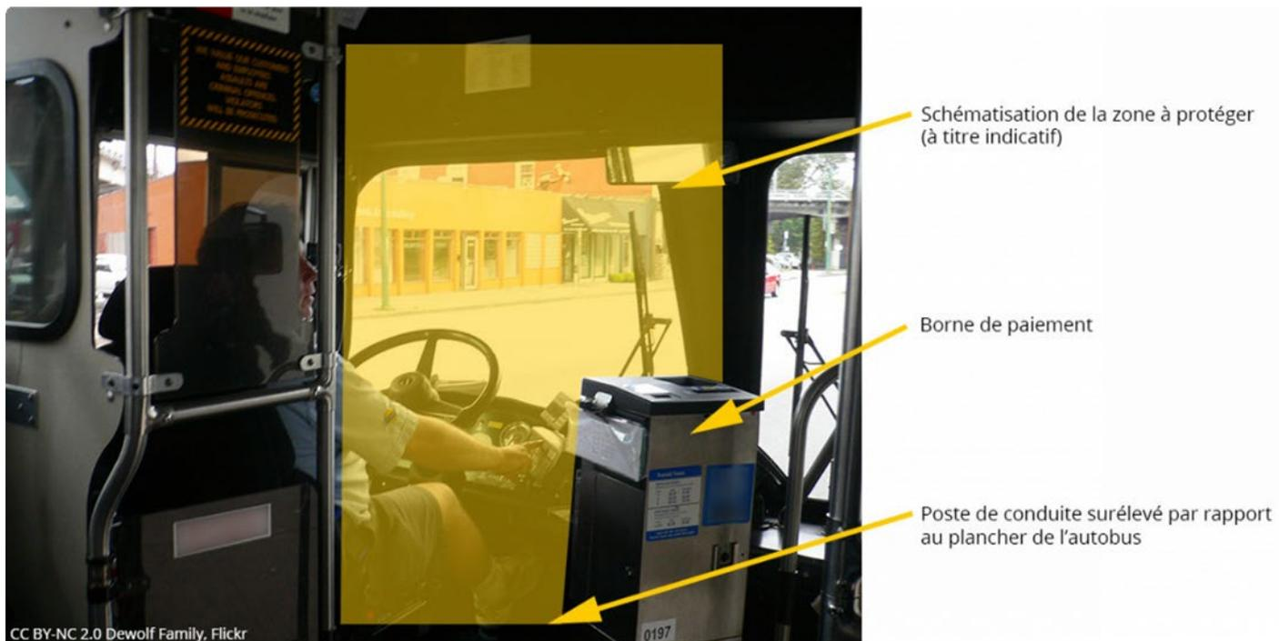
Exemple d'un poste de conduite d'un autobus conçu pour le transport urbain.
