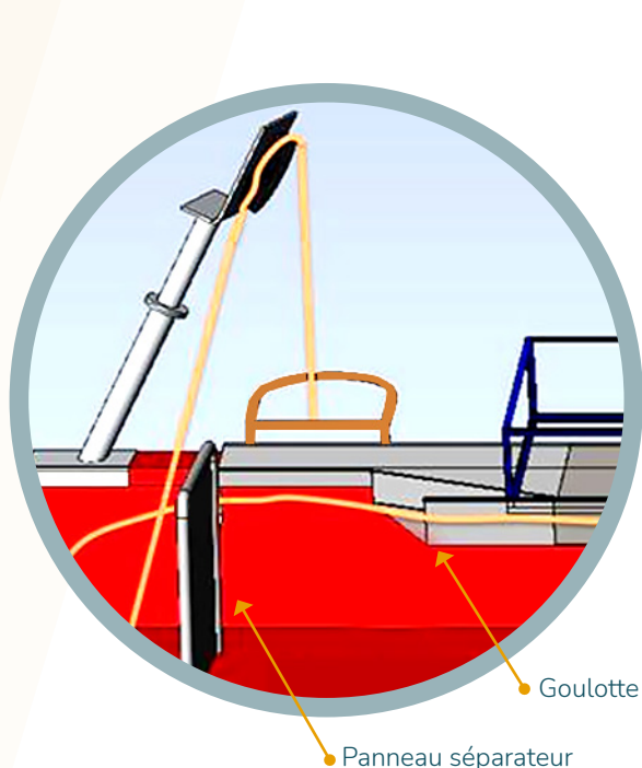
Panneau séparateur du cordage avec haleur incliné en hauteur
