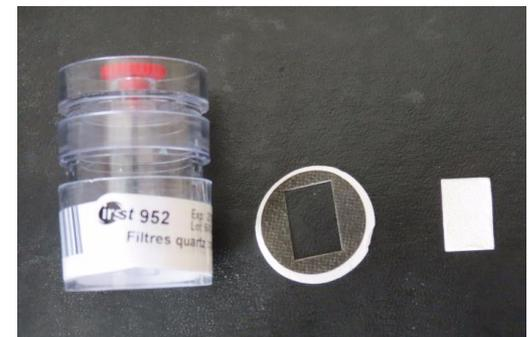
Filtre avant analyse et portion de filtre après analyse
