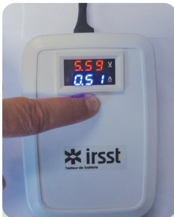
**Figure 2:** Testeur avec une batterie branchée et le bouton pressé.
