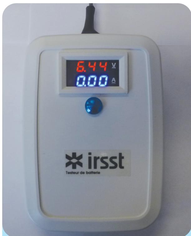
**Figure 1:** Testeur avec une batterie branchée (bouton non pressé).
