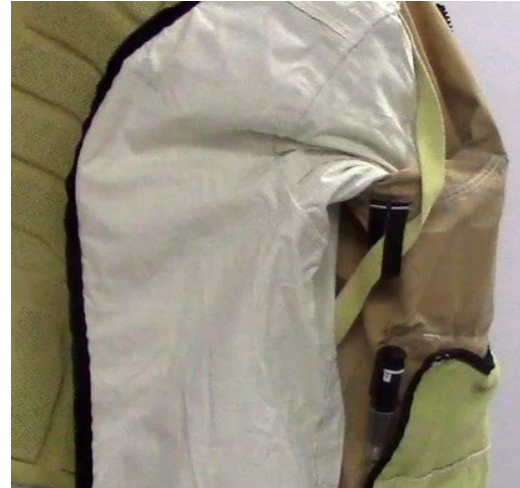
Figure 11. Capteur de température et d'humidité à l'intérieur du vêtement situé dans la couche externe
