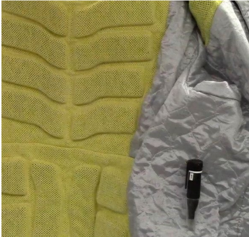
Figure 10. Capteur de température et d'humidité à l'intérieur du vêtement situé dans la couche interne
