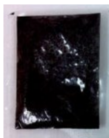
Pochette de sels hydratés ignifuges, constituants le MCP
