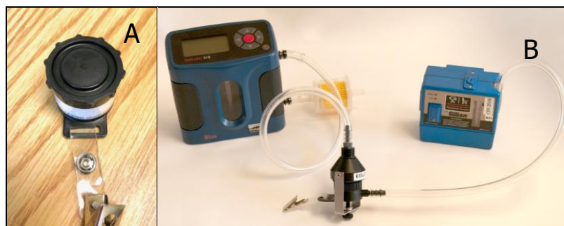
Figure 1. cassette CIJ avec capuchons (A) et avec adaptateur pour calibration (B)
