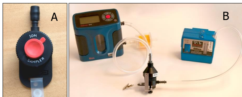
Figure 1. Échantillonneur IOM avec capuchons (A) et avec adaptateur pour calibration (B)
