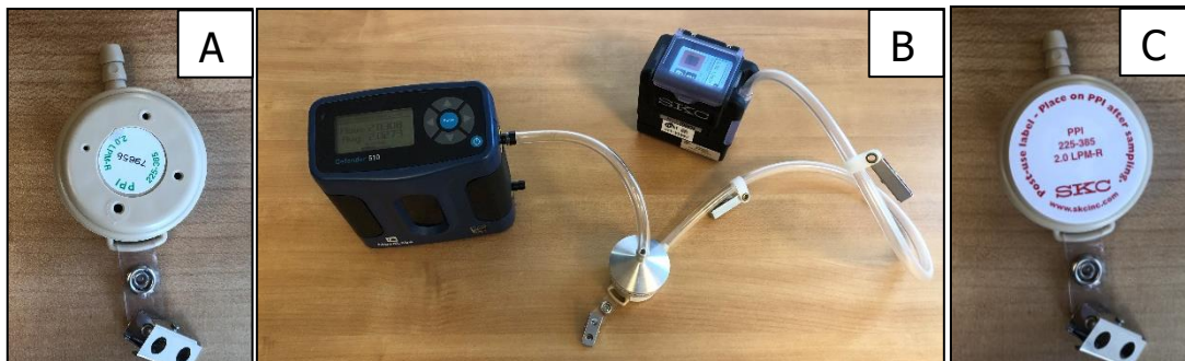
Figure 1. Impacteur PPI (A), avec adaptateur pour calibration (B) et impacteur PPI (C) avec collant suite à l'échantillonnage.
