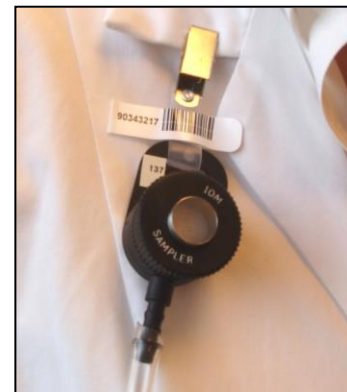
Échantillonneur IOM installé sur un travailleur (code 956)
