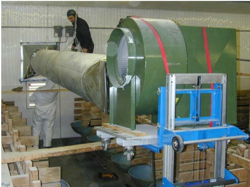
Figure 9. Mesure des débits de ventilation à l'aide d'une conduite calibrée
