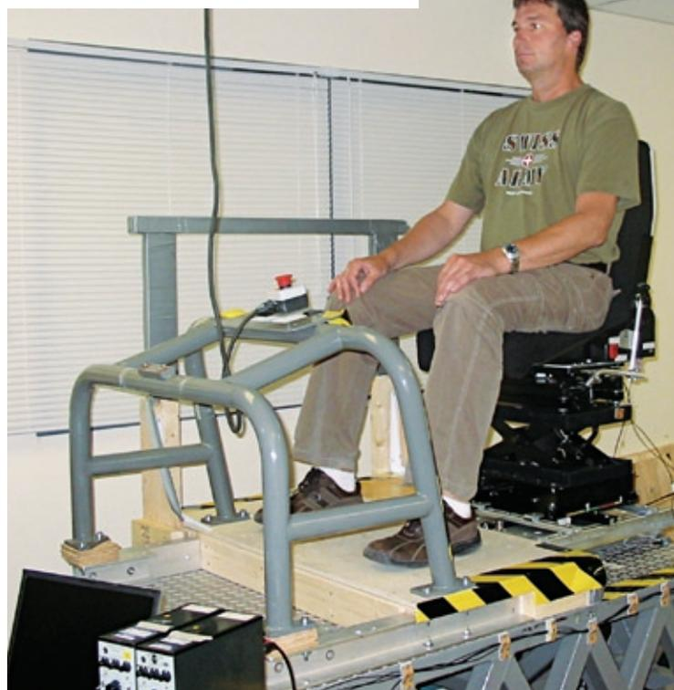
**Créer un prototype de siège a nécessité plusieurs étapes auxquelles des opérateurs de métro ont participé. Parmi celles-ci, des simulations dans une maquette de loge de grandeur réelle et des tests sur un simulateur de vibrations.**
