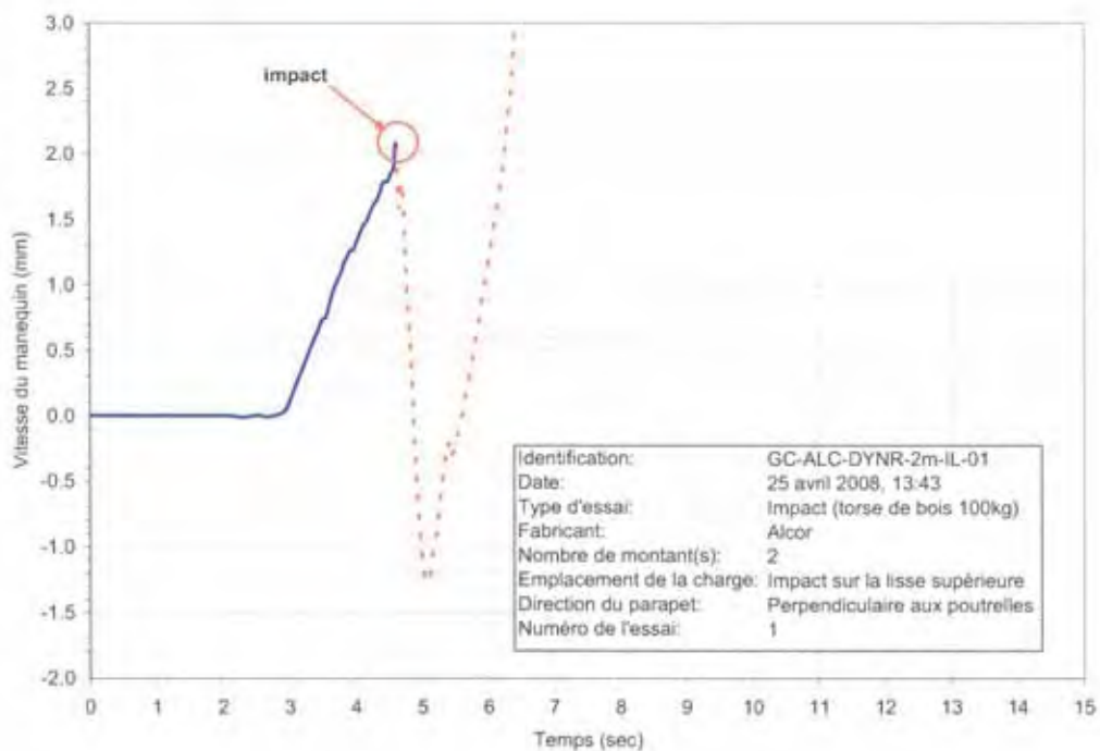
Figure F-73 – Essai dynamique d’impact GC-ALC-DYNR-2m-IL-01 : Vitesse du mannequin (1 travée, impact sur la lisse supérieure).
