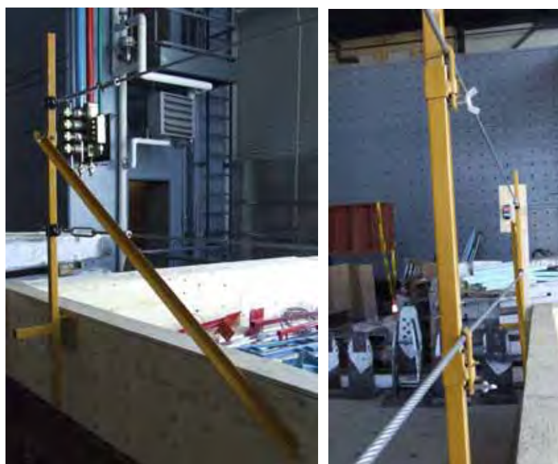
Figure F-8 - Garde-corps Innovation Malenfant Inc., (a) avec stabilisateur de poteau avec câbles en acier pour la lisse supérieure, (b) avec stabilisateur de poteau avec tubes en acier pour la lisse supérieure.
