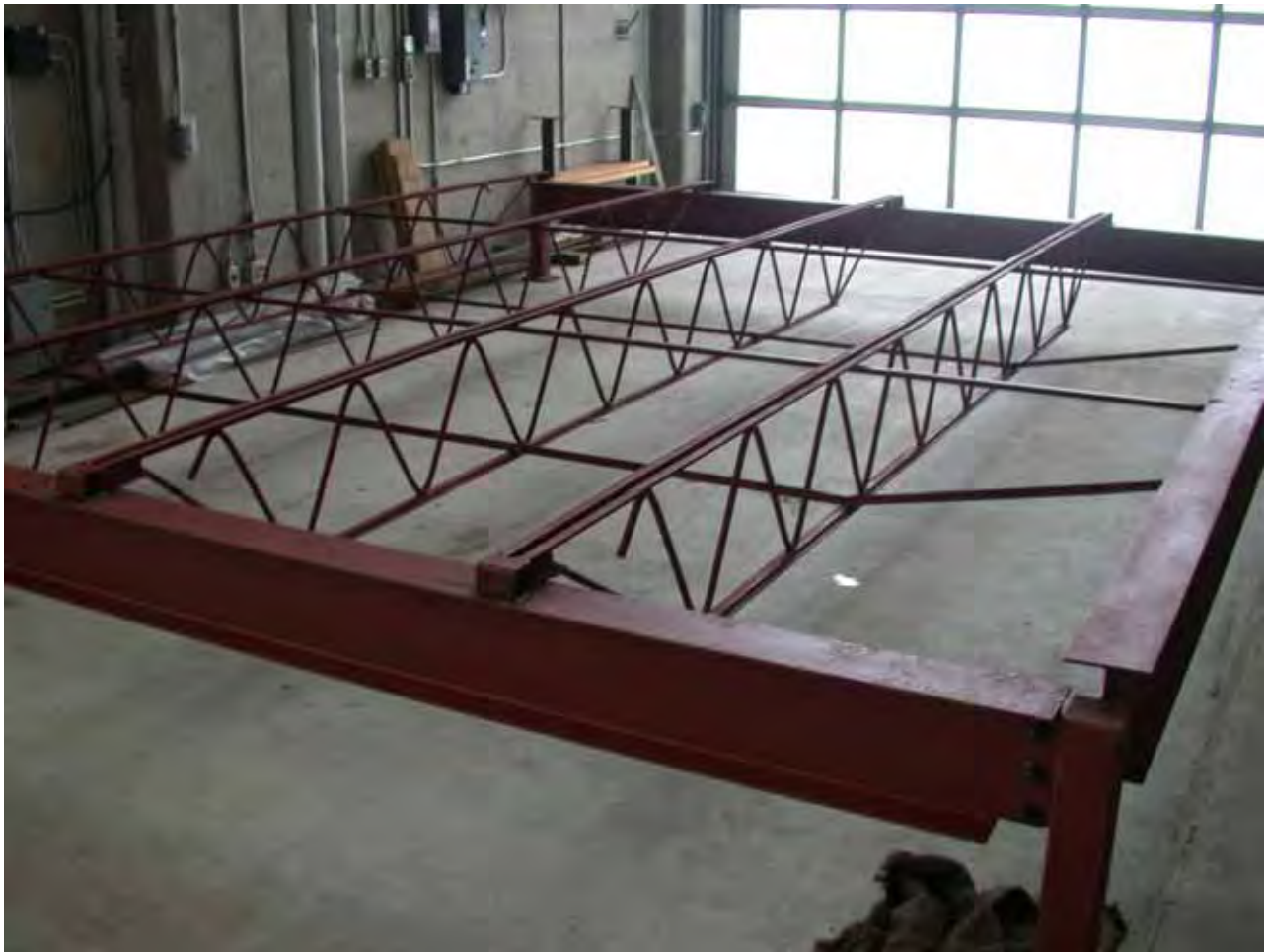
Figure F-16 – Essais statiques de résistance sur une seule travée ancrée à la bille de bois.
