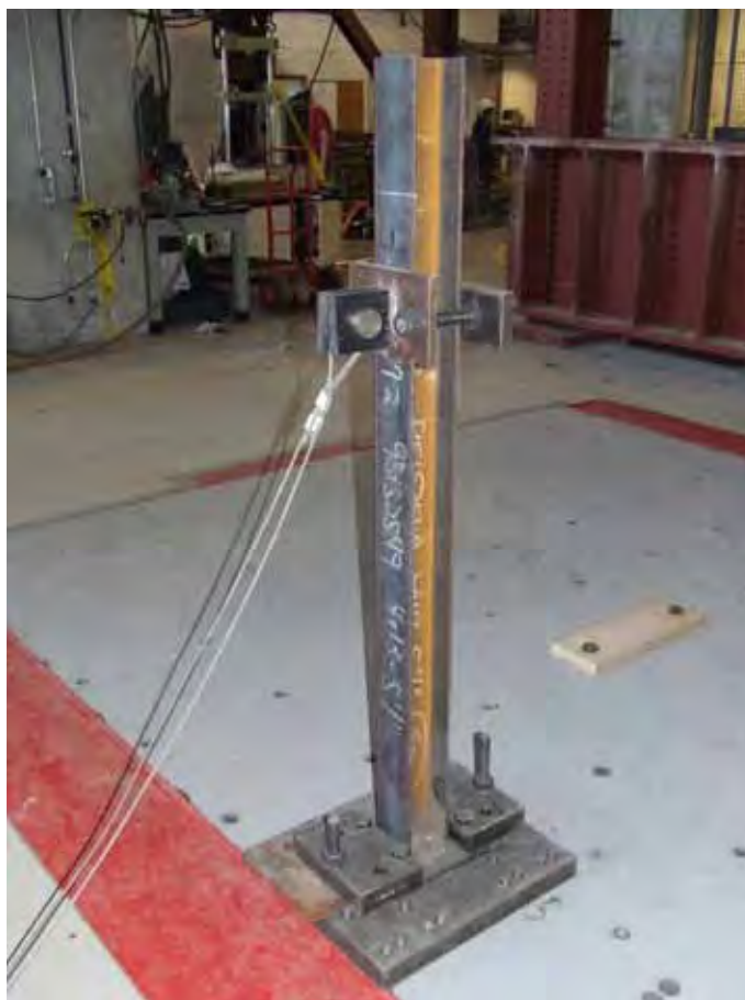
Figure F-14 - Colonne d'acier montée sur le simulateur sismique.
