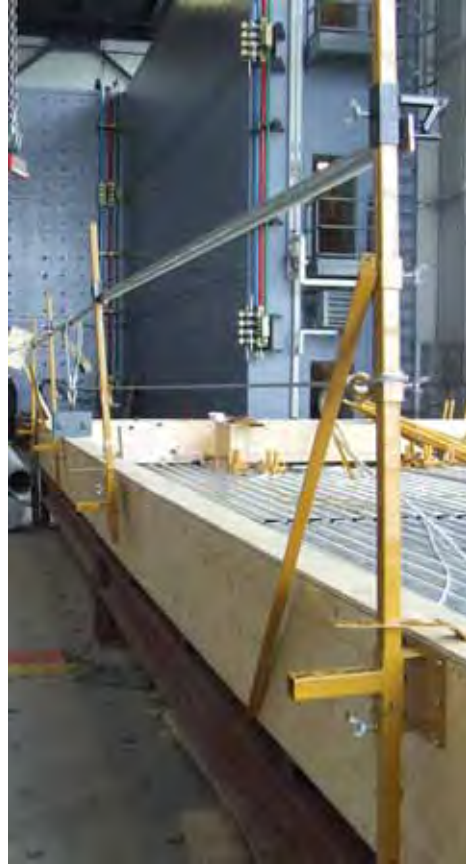
Figure F-9 - Garde-corps Innovation Malenfant Inc. avec stabilisateur de poteau et tubes en acier pour la lisse supérieure.
