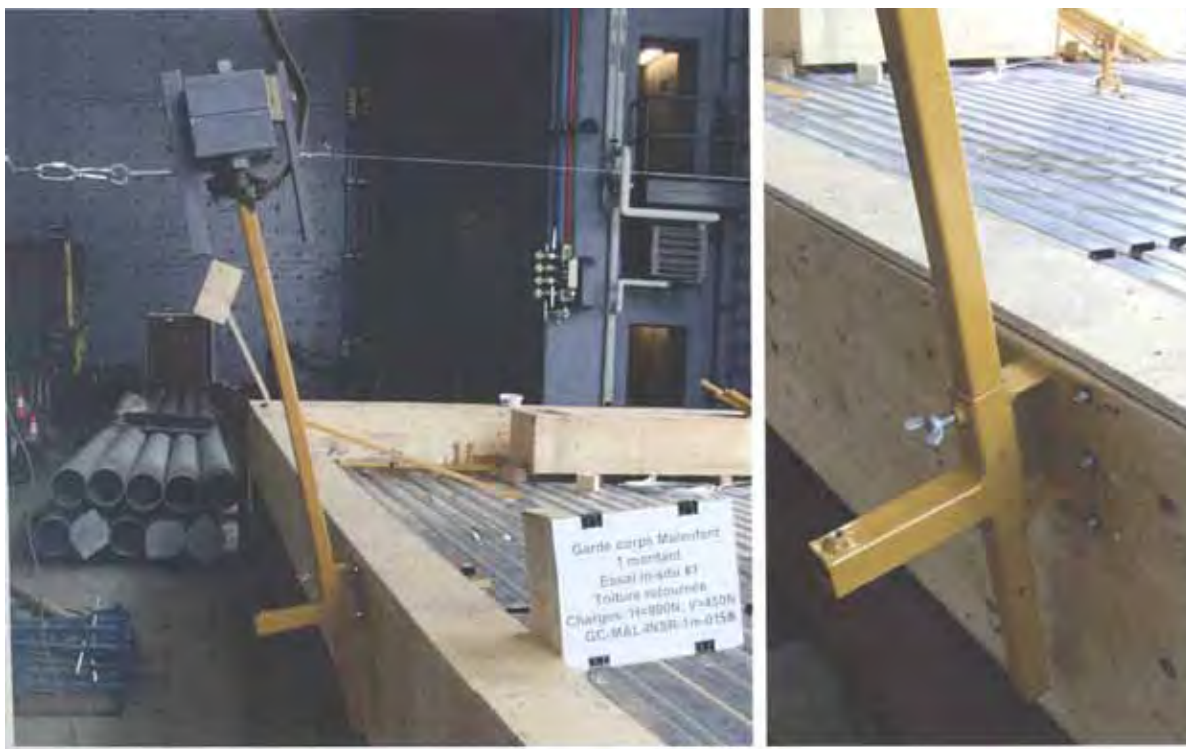
Figure F-132 – Essai GC-MAL-INSR-1m-03SB lorsque la charge a atteint 620 N.
