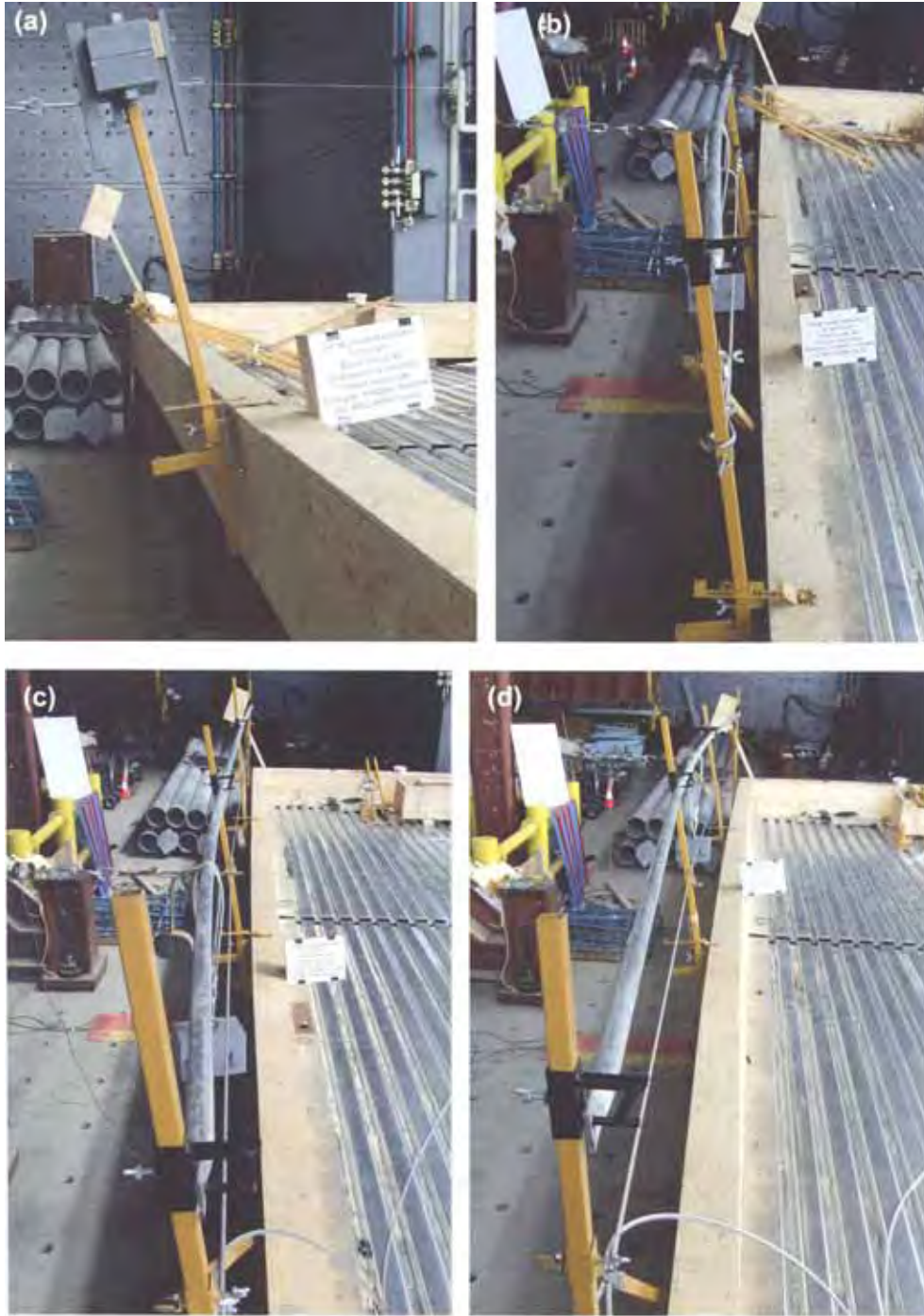
Figure F-127 – Essais INSR Innovation Malenfant Inc. avec charge horizontale égale à 900 N :
