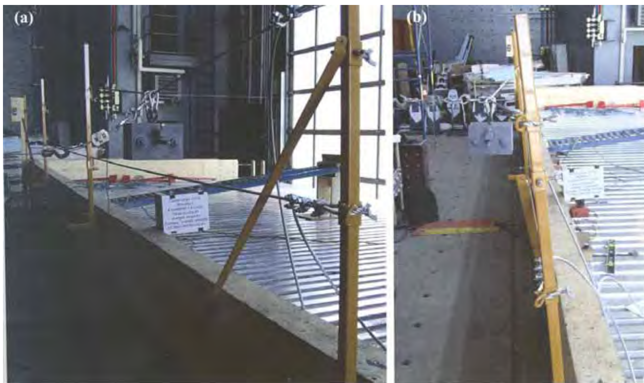
Figure F-112 – Essais avec câble d’acier pour lisse supérieure.
