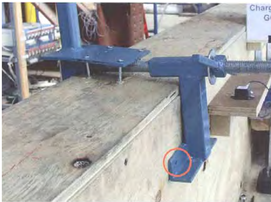
Figure F-49 – Vis manquante sur la plaque arrière du pied d’ancrage pour l’essai GC-ALC-INS-1m-01.
