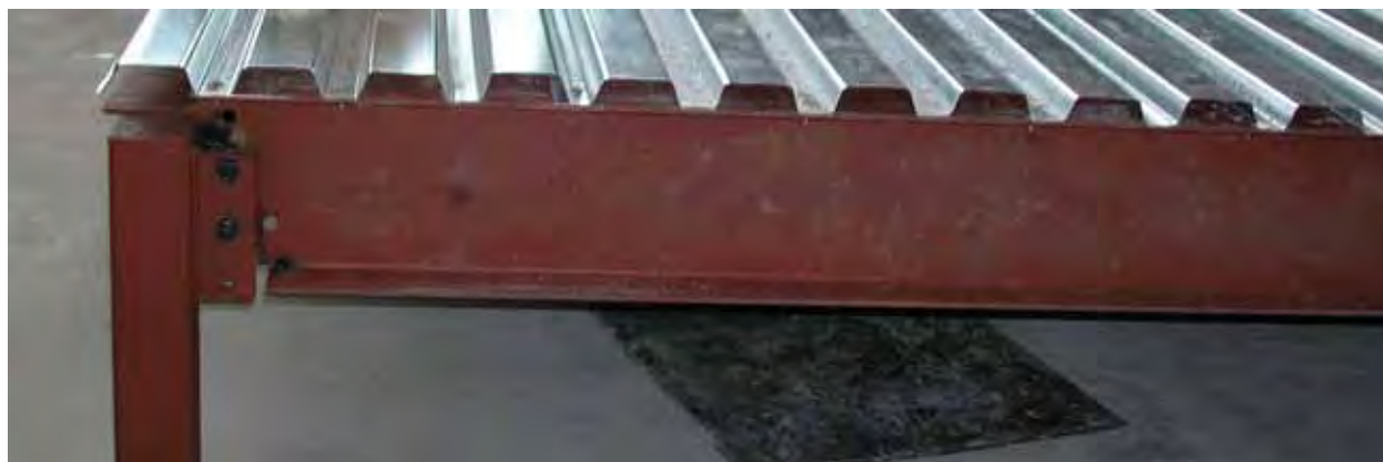
Figure F-23 - Bord de toiture avec flexibilité minimale pour l'assise du parapet (série d'essais INS).
