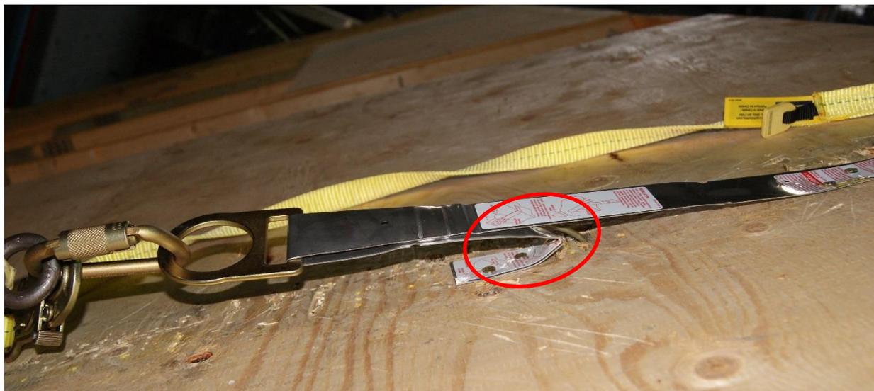
**Figure 71 - Essai 8 sur le connecteur d'ancrage Ridge : état du connecteur d'ancrage après l'essai.**
