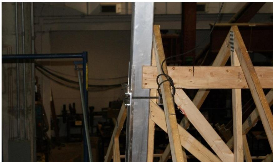
Figure 54 - Rupture au niveau du faîte de toit du côté *est*, lors de l'essai 6 du Tableau 6.
