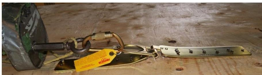
**Figure 64 - Essai 9 avec le connecteur d'ancrage Protecta : soulèvement et déclouage partiel de la patte supérieure du connecteur d'ancrage.**
