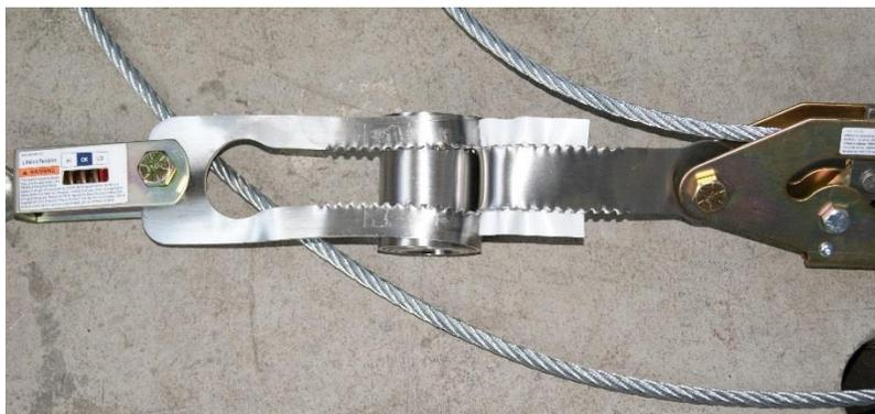
**Figure 45 - Déploiement du système Zorbit avec 14 déchirures lors de l'essai 5 du Tableau 4.**
