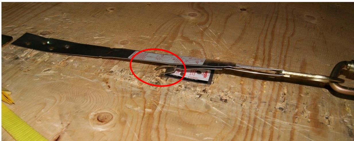
**Figure 72 - Essai 9 sur le connecteur d'ancrage Ridge : état du connecteur d'ancrage après l'essai.**
