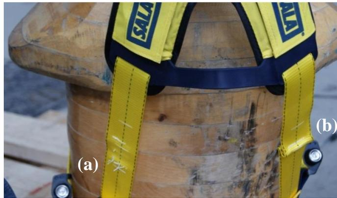
Figure 39 - Indicateurs d'arrêt de chute du harnais : (a) activé; (b) non décousu.
