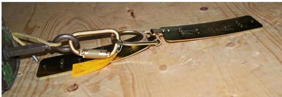
**Figure 62 - Essai 8 avec le connecteur d'ancrage Protecta : soulèvement et déclouage partiel de la patte supérieure du connecteur d'ancrage.**
