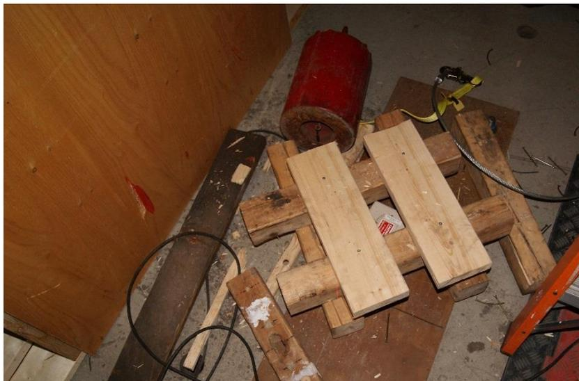
**Figure 67 - Essais 7 sur le connecteur d'ancrage DBI : chute au sol de la masse d'acier.**
