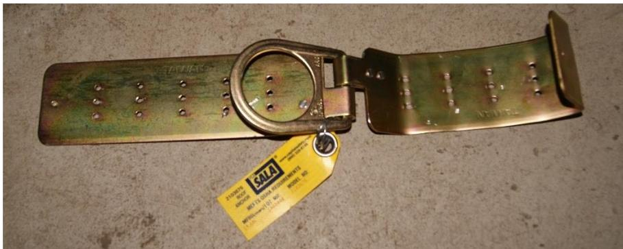
**Figure 66 - Essai 7 sur le connecteur d'ancrage DBI : état du connecteur d'ancrage après l'essai.**
