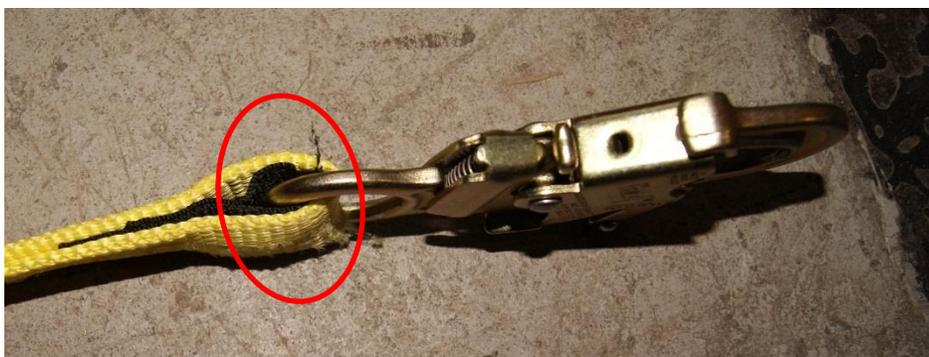
**Figure 63 - Essai 8 avec le connecteur d'ancrage Protecta : endommagement partiel de l'attache du crochet à ressort du cordon d'assujettissement à sangle en nylon.**
