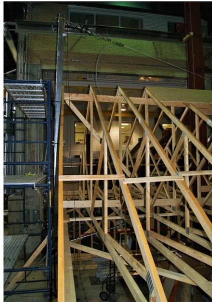
**Figure 52 - Rupture de la diagonale et de la lisse supérieure du côté *est*, lors de l'essai 1 du Tableau 6.**
