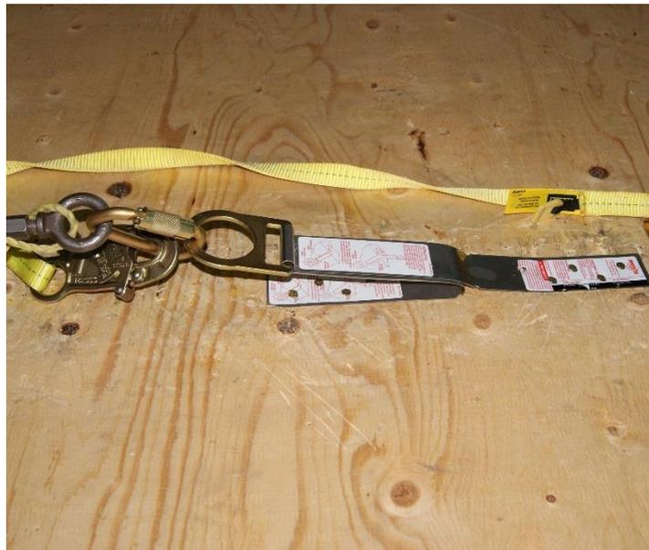
**Figure 9 - Connecteur d'ancrage de toit Ridge.**
