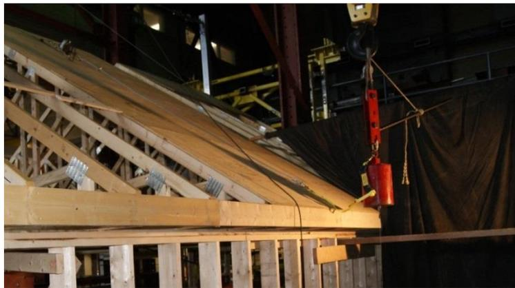
**Figure 56 - Essai 2 : connecteur d'ancrage Ridge.**
