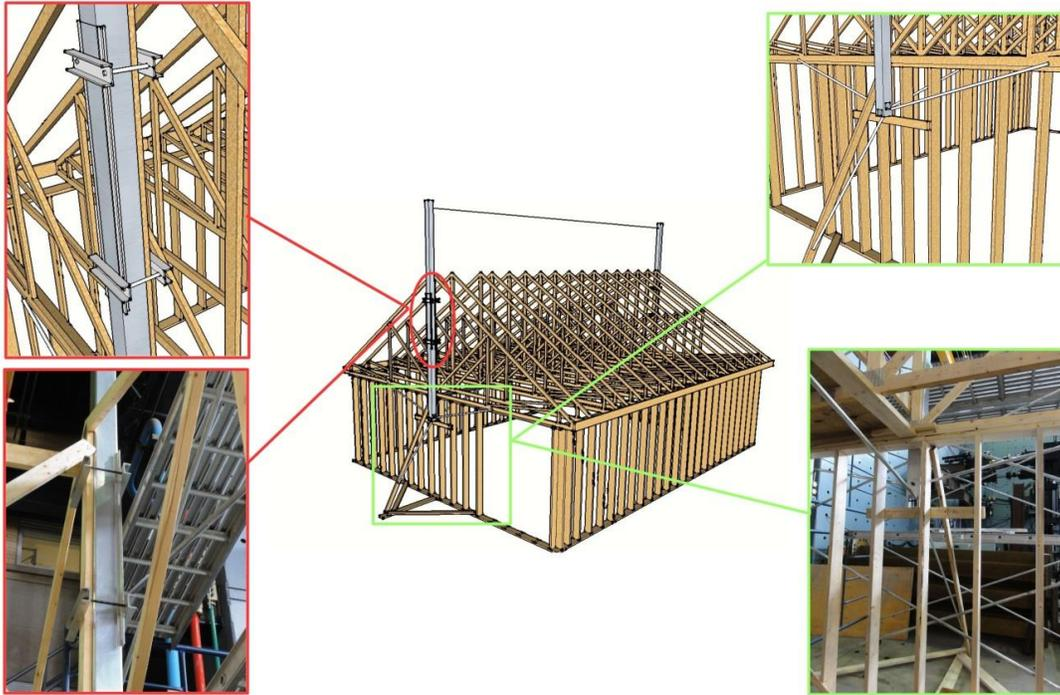
Figure 17 - Fixation du potelet à la structure d'accueil.
