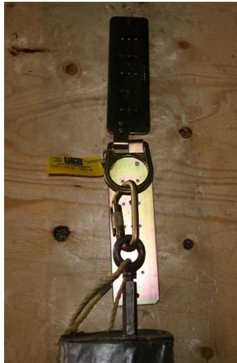
**Figure 10 - Connecteur d'ancrage de toit DBI.**
