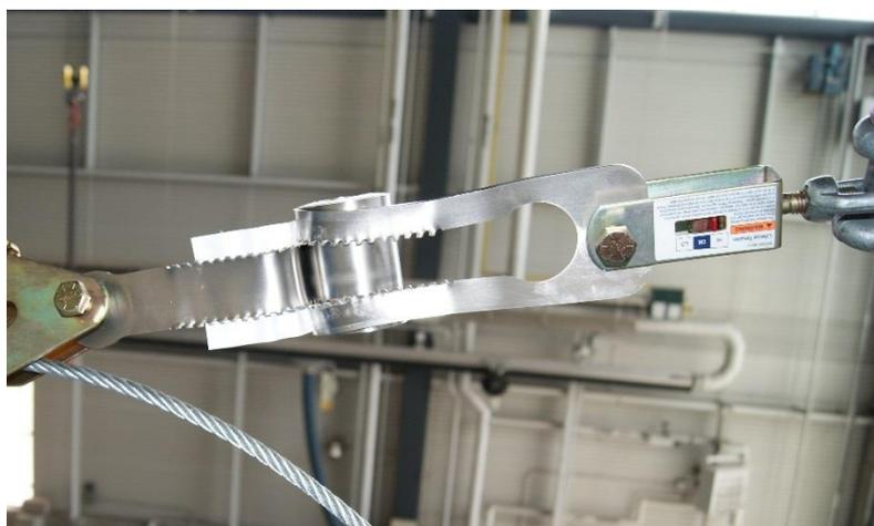
**Figure 46 - Déploiement du système Zorbit avec 13 déchirures lors de l'essai 6 du Tableau 4.**
