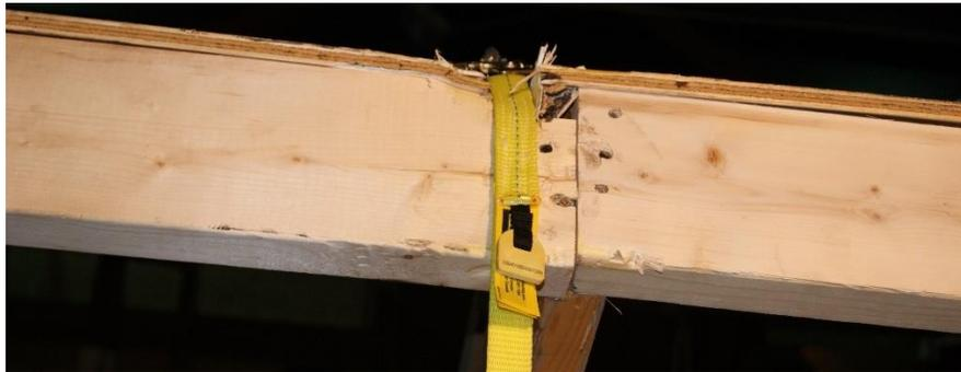
**Figure 65 - Essai 9 avec le connecteur d'ancrage Protecta : endommagement de la corniche de la toiture.**
