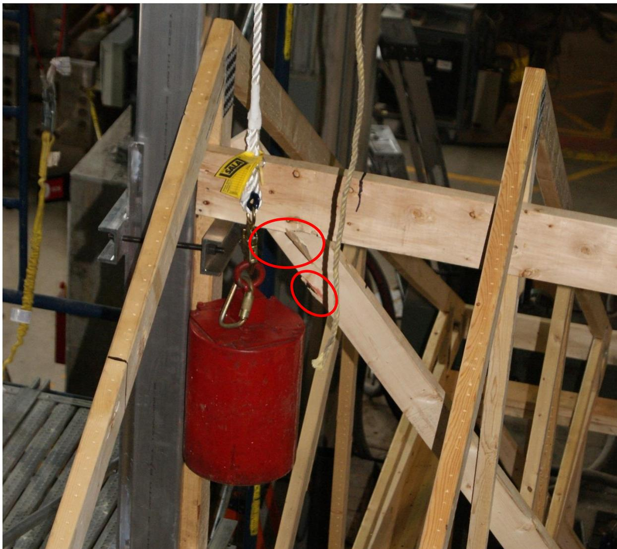
Figure 50 - Légers endommagements à la structure d'accueil à la suite de l'essai 4 du Tableau 5.
