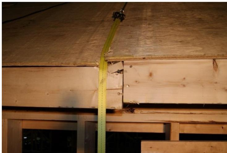
**Figure 61 - Rupture de la corniche de toiture lors de l'essai 8 avec le connecteur d'ancrage Protecta.**
