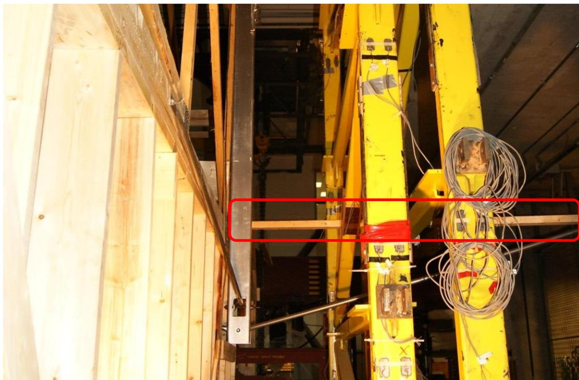
**Figure 19 - Madrier 2 po x 6 po pour l'ancrage du croisillon *est* du potelet côté *est*.**
