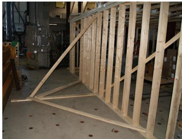
Figure 18 - Structure supplémentaire pour l'ancrage du croisillon *ouest* du potelet *ouest*.
