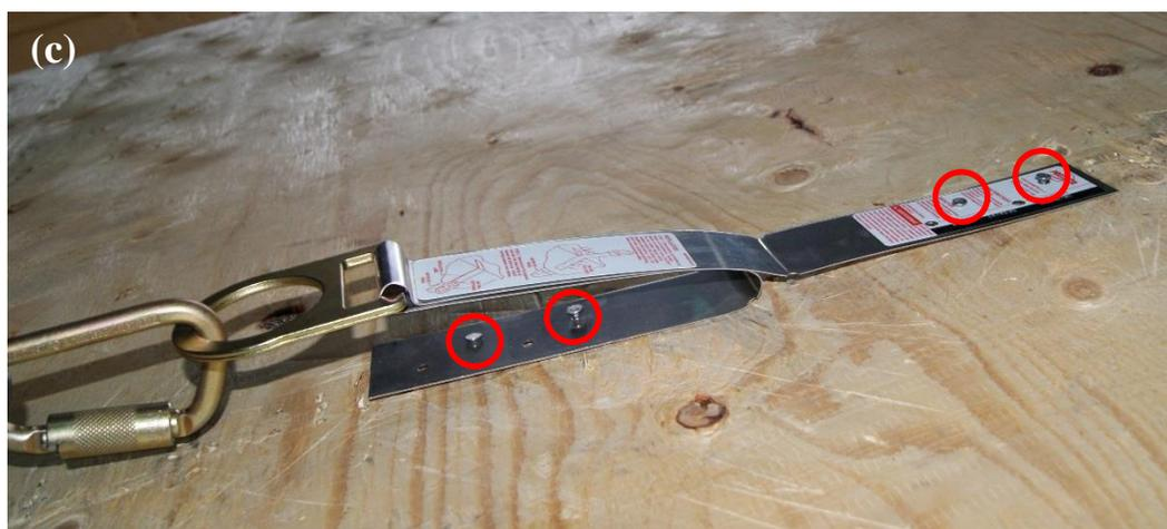
**Figure 37 - Clouage des connecteurs d'ancrage pour l'essai 3 du Tableau 7 : (a) Protecta; (b) DBI; (c) Ridge.**
