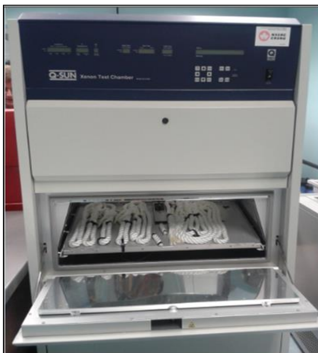
Figure 15. Chambre de vieillissement à lampes de Xénon.
