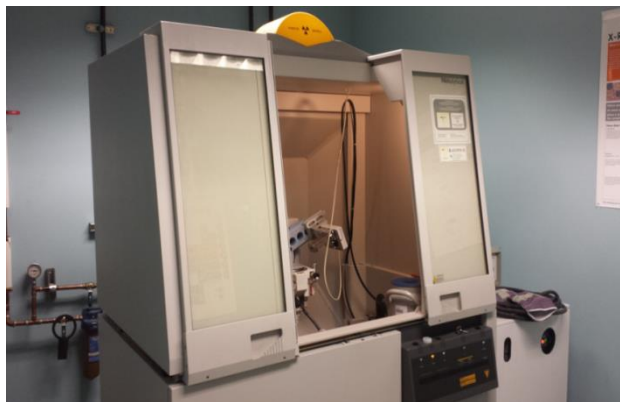
Figure 17. Diffractomètre utilisé pour les essais de diffraction des rayons X.
