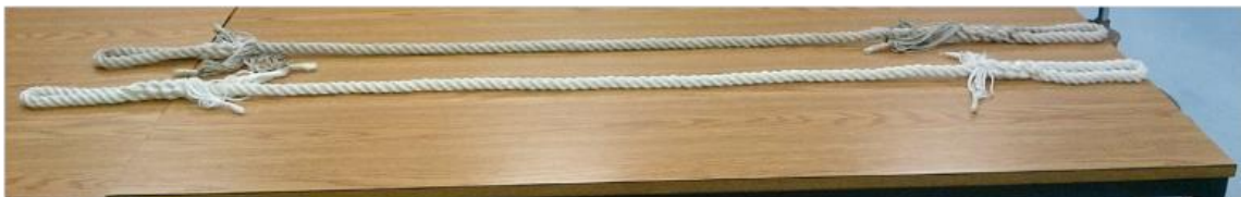
Figure 29. Comparaison de la longueur d'une corde en polyamide à l'état neuf (en bas) et après six mois de vieillissement naturel (en haut).
