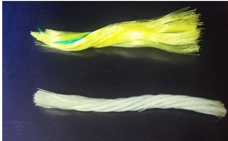
Figure 46. Comparaison du teint des cordes de PP non vieilles (haut) et vieilles naturellement pendant 18 mois (bas).
