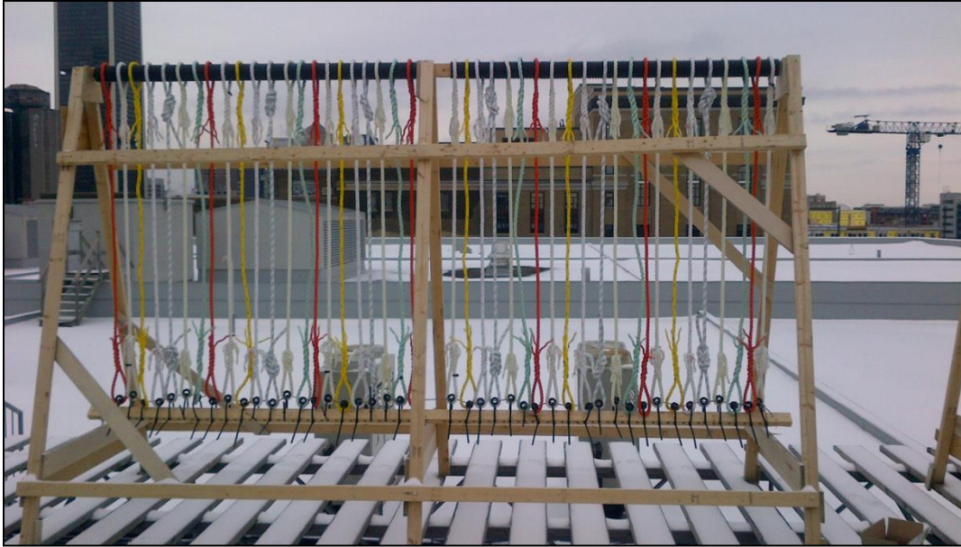
Figure 14. Ensemble des cordes exposées aux intempéries sur le toit d'un bâtiment à l'ÉTS.
