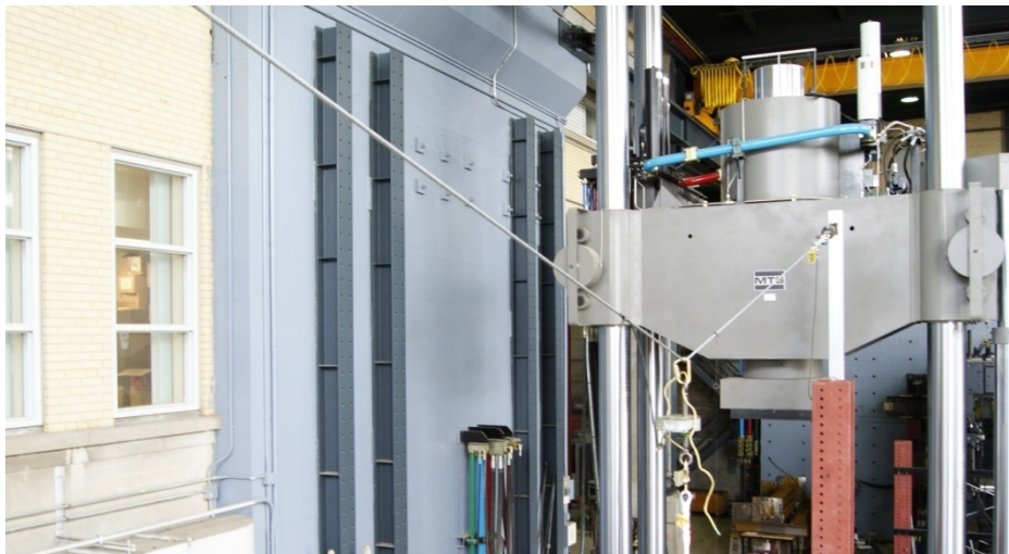
Figure 27 - Flèche du câble d'acier engendrée par une masse suspendue de 100 kg à mi-portée (Tirée de Leclerc et Tremblay, 2015).
