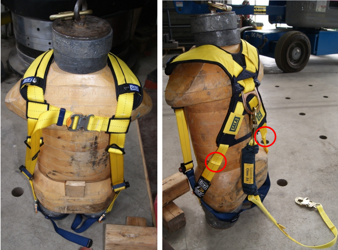
Figure 22 - Torse de bois équipé d'un harnais de sécurité et d'un cordon d'assujettissement avec absorbeur d'énergie de classe E4 (Tirée de Leclerc et Tremblay, 2015).
