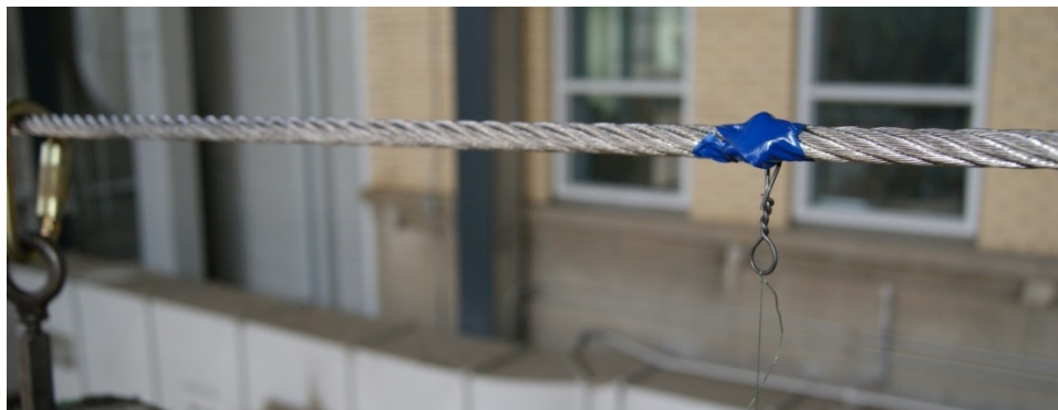
Figure 26 - Point d'attache au câble pour la mesure de la flèche (Tirée de Leclerc et Tremblay, 2015).
