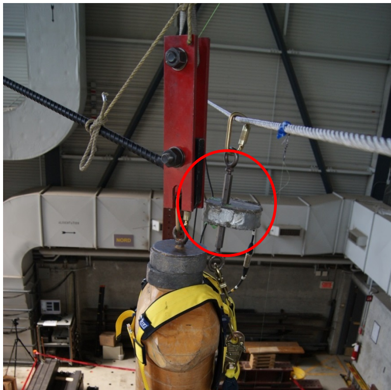
Figure 24 - Cellule de charge de 22,3 kN pour la tension du cordon d'assujettissement (Tirée de Leclerc et Tremblay, 2015).
