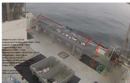
Photo 7 Illustration d'un aménagement de bateau en situation de pêche régulière
