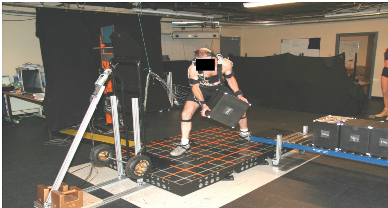
Figure 2.2 Illustration du plateau expérimental de la condition à 90 °. Le participant effectue un transfert du convoyeur vers le diable
