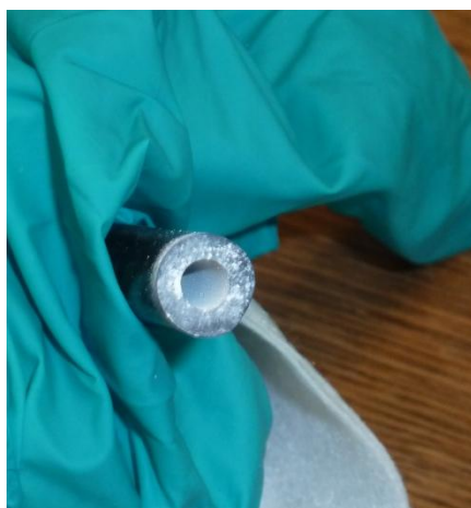
Figure 7 - Photo de l'entrée du tuyau du SMPS après une tentative de détection de NPs de \text{TiO}_2 en poudre
