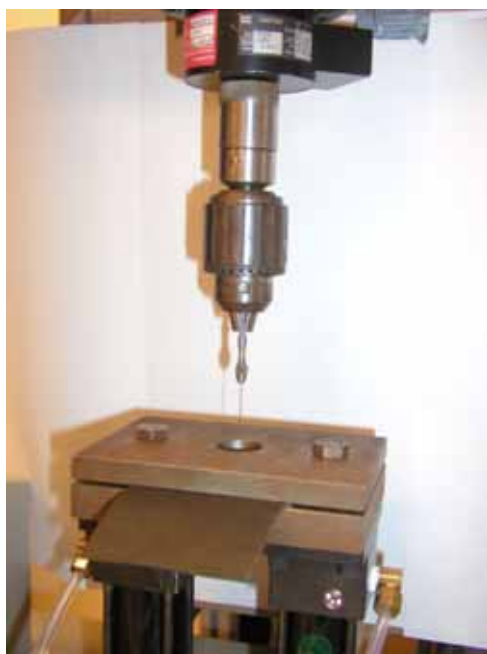
Figure 6 – Photo du montage de perforation par une aiguille
