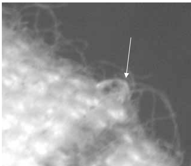
Figure 25 – Image par microscopie optique de l'interaction entre la pointe de l'aiguille et un fil de support tissé lors de la perforation d'un échantillon de TurtleSkin® D 006-a (renfort tissé avec enduit polymère)
