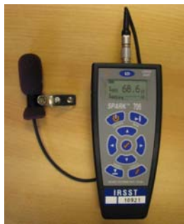
Figure 1: Dosimètre Larson Davis (Spark 706) utilisé pour les mesures
