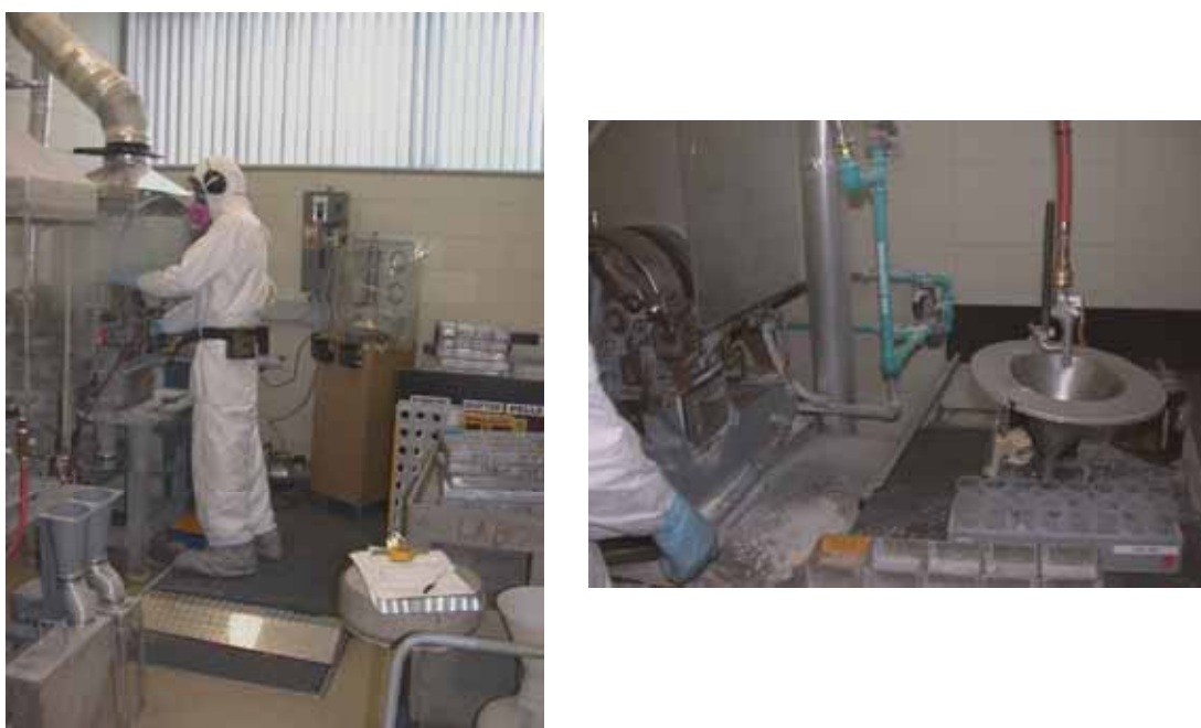
Figure 3 : Poste de réduction du bain électrolytique
