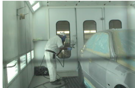
Figure 4-13 – Peinture d'une surface verticale
