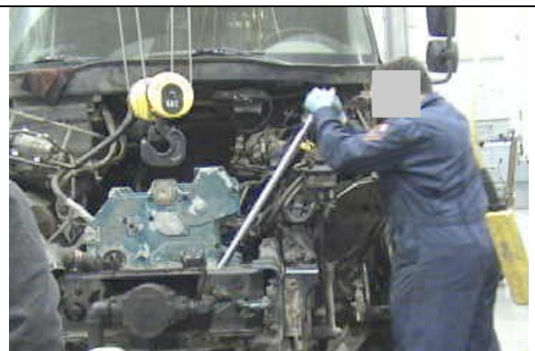
Figure 4-30 – L'utilisation d'un outil avec un long manche permet de déployer un couple de serrage plus élevé en utilisant moins de force.
