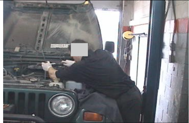
Figure 4-26 – Utilisation d'une extension sur la clé à rochet permet de répartir l'effort sur les autres articulations des membres supérieurs (coude et épaule) et d'impliquer le tronc pour produire la rotation.
