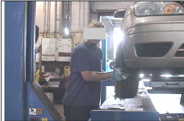
Figure 4-35 - L'utilisation d'un système d'élévation avec des rampes éloigne la charge (ici, le pneu) au moment de la prise.
