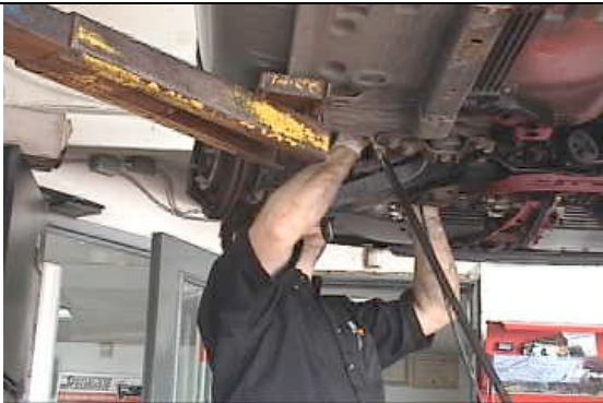
Figure 4-27 - Visser avec le bras tendu au-dessus de la tête implique une contrainte musculaire importante à l'épaule.
