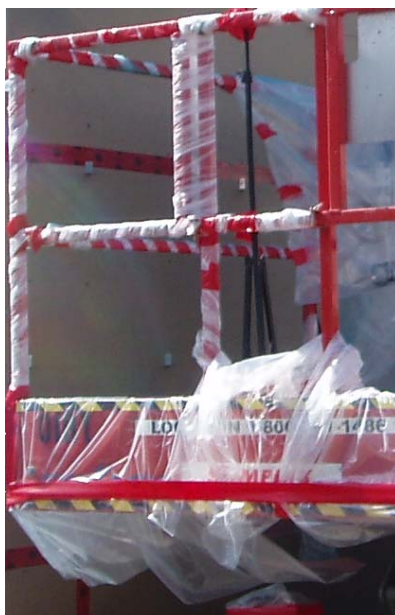
Figure 9 : Protection des membrures et traverses d'un équipement de levage
